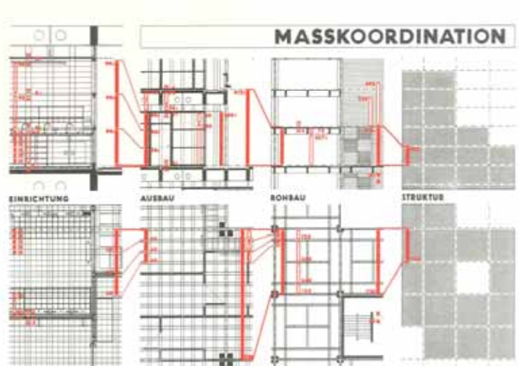
Fig. 66. Helmut Spieker. Marburger Bausystem . Hoja del catálogo de elementos. Coordinación de dimensiones de mobiliario, interior, fábrica y estructura. (Langenberg 2013)
