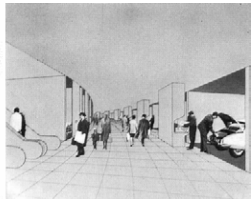
Fig. 145c (arriba). Parking inferior. Acceso (izda.) - salida (dcha.), cada uno con 4 carriles. En el centro, los boxes de entrada están dispuestos en círculo. Después de entrar, el cliente recibe una tarjeta codificada, el automóvil se eleva sobre un montacargas hasta el piso superior; entre los puestos de entrada y salida, zona reservada para peatones. La recogida del coche tiene lugar al mismo tiempo que la recogida de la mercancía.
