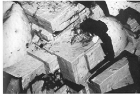
Struktur der Oberfläche einer etched Aluminiumplatte hergestellt in Zürich. Aufnahme mit dem Elektronenmikroskop. Tisch, Thoner & Co. Zürich. The surface structure of an etched aluminum plate, magnified 20,000 times, as revealed in a photograph taken with the electronic microscope made by Tisch, Thoner & Co., Zürich. Structure d'une plaque d'aluminium corrodée agrandie 20 000 fois au microscope électronique Tisch, Thoner & Co., Zurich.
