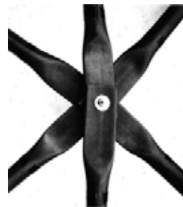
Fig. 245. Entramado curvo de barras de planta cuadrada. Departamento de Construcción. 2º y 3º año de estudio, curso 62/63. Estudiantes: Heinz Dobrinski, Horst-Josef Schu, Max Thanner, Howard Petersen. Profesor: R. Doernach. Detalles del nudo por calentamiento, aplastamiento y atornillado de los tubos de plástico. (Dobrinski, Schu, Thanner, et al. 1963).
