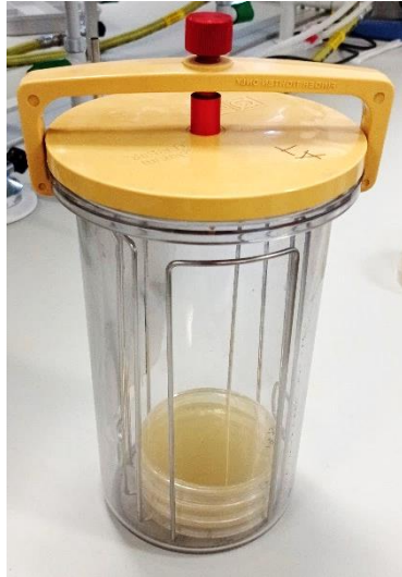
Figura 7. Equipo productor de anaerobiosis GasPak Anaerobic System.
