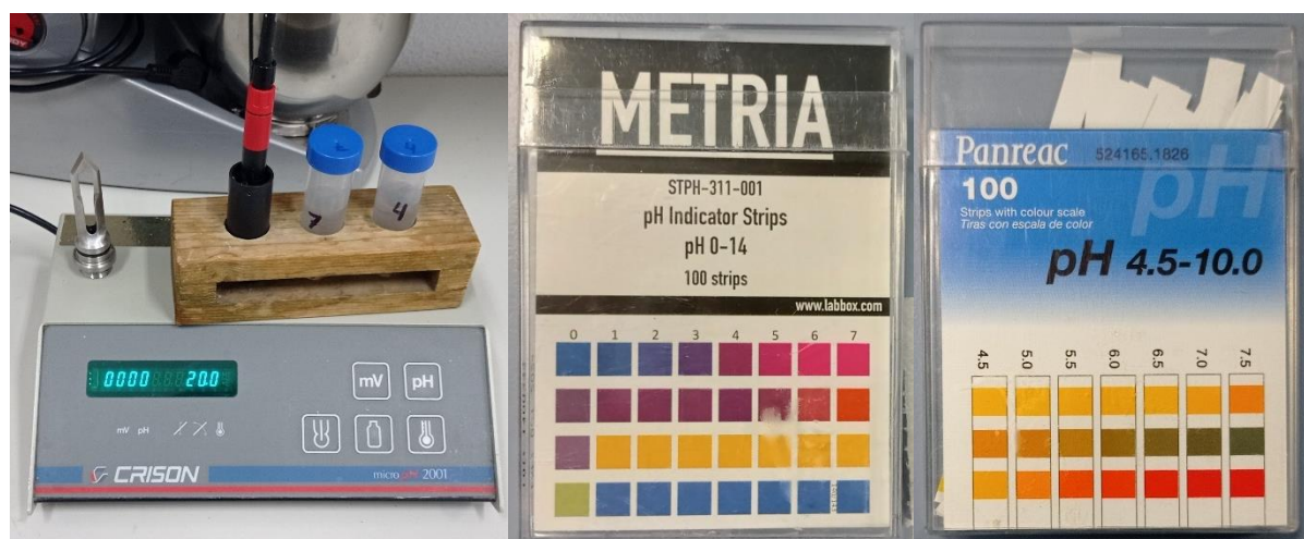
Figura 9. pH-metro Crison micropH 2001 (izquierda). METRIA pH Indicator Strips STPH-311-001 (centro). Tiras con escala de color PanReac (derecha).
