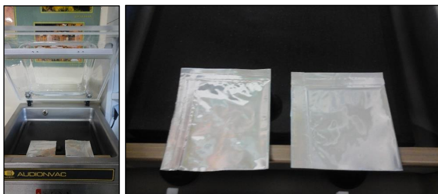
Figura 2. Termosellado hermético de sobres de aluminio para el almacenamiento de semillas de cebolla.
