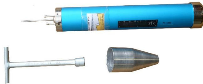
Figura 15. Pilodyn con tapa metálica y pieza en T para su carga.
