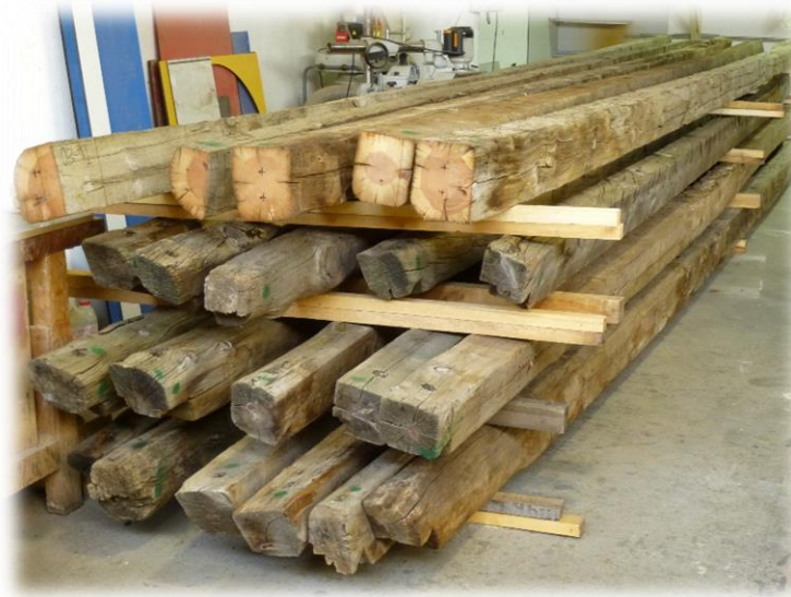
Figura 6. Pila de piezas de madera completa de 11 m de longitud en las instalaciones de Intrama S.A.
