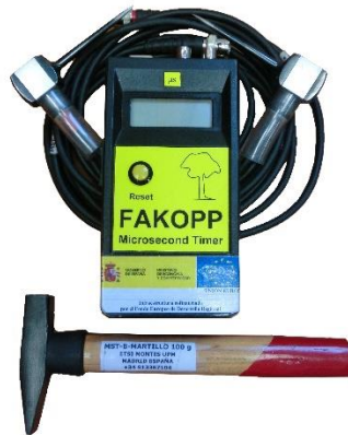
Figura 11. MicroSecond Timer con sensores con forma de pincho y martillo de accionamiento de la onda acústica.
