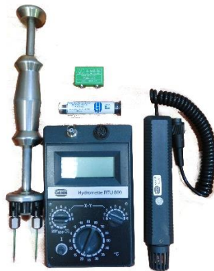
Figura 13. Xilohigrómetro de resistencia eléctrica Hydromette RTU 600 con electrodos, calibrador, captador de humedad ambiental.
