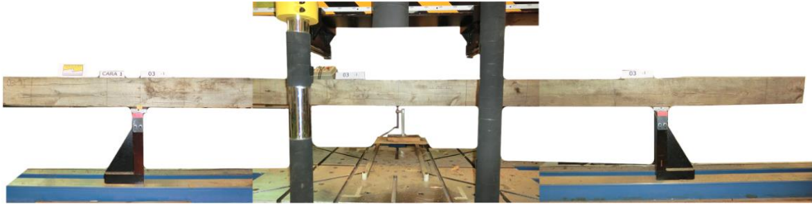
Figura 8. Ensayo a flexión biapoyado según norma UNE-EN 408:2011+A1:2012 (2012). Ejemplo de disposición de la pieza no. 03-I reconstruyendo la imagen a partir de tres imágenes frontales.
