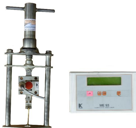
Figura 16. Equipo de arranque de tornillos con célula de carga, soporte y consola.
