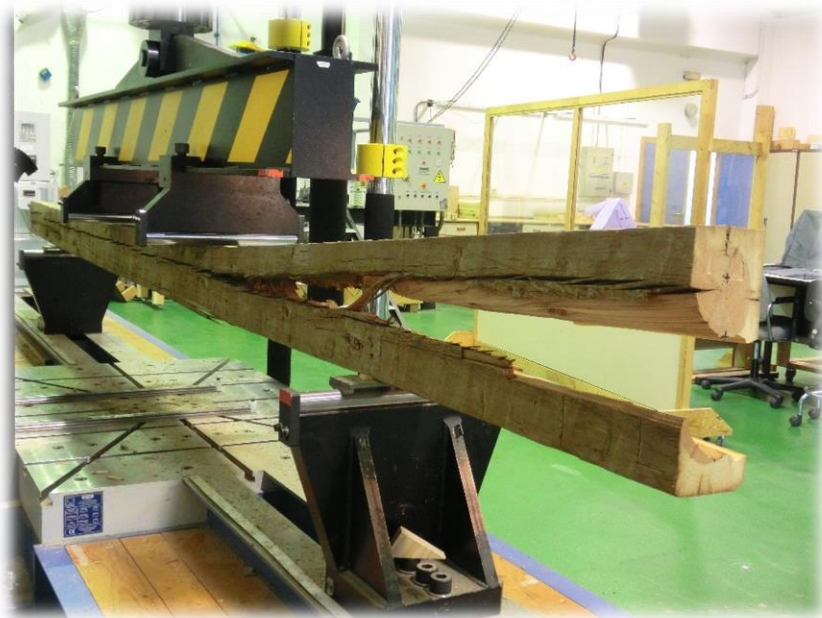
Figura 28. Ejemplo la disposición del ensayo a flexión de la pieza corta No. 13-II de acuerdo con la norma UNE-EN 408 (2012). Fenómeno de fallo: rotura por cortante.
