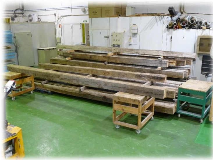
Figura 7. Pila de madera de piezas seccionadas preparadas para su traslado a la zona de ensayo.
