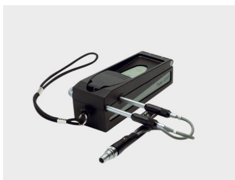
Figura 15. Calibrador para una sonda p-p de Brüel & Kjaer [14].
