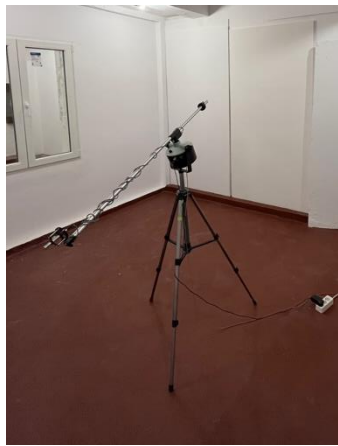
Figura 10. Micrófono montado sobre trípode en el recinto receptor.
