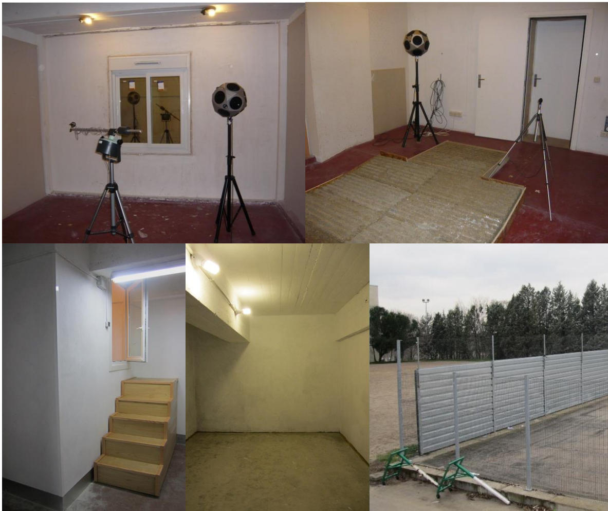
Figura 8. Instalaciones de ArquLAV. Arriba: Cámara reverberante. Abajo Izda.: Cámara de transmisión vertical. Abajo dcha.: Recinto para ensayos de barreras acústicas.[13]
