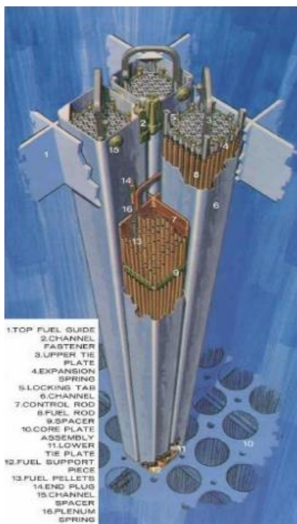
Figura 4: Elemento combustible y barra de control cruciforme
