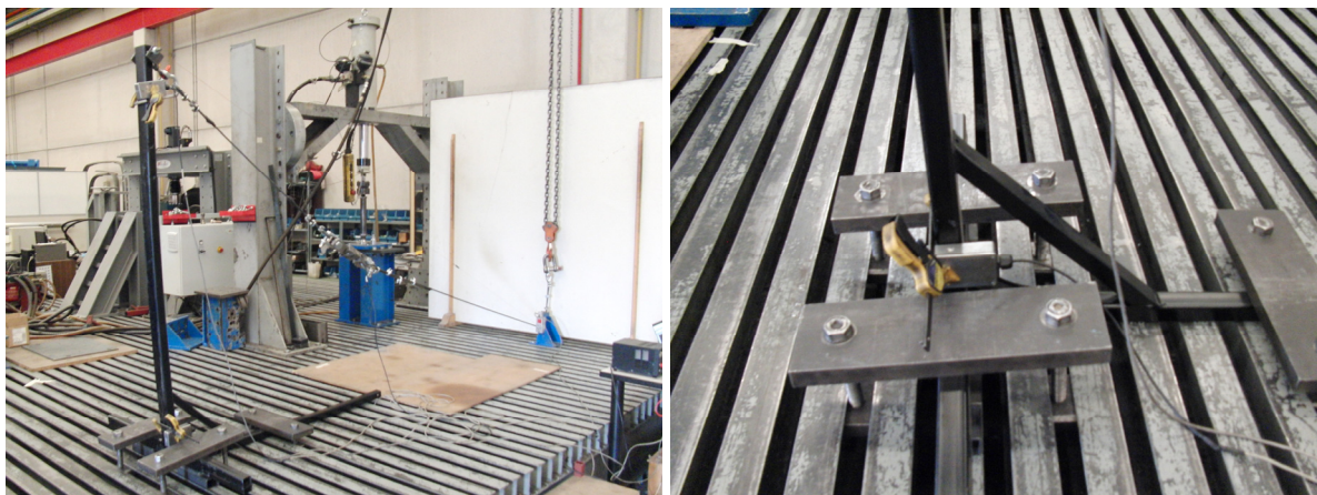
Figura 180. Montaje de la unión sobre la bancada de ensayo.
