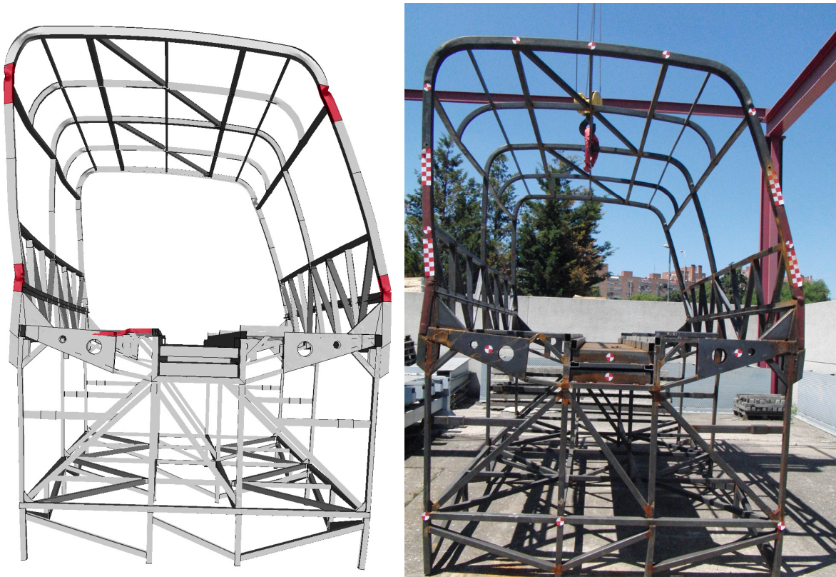
Figura 158. Estructura general en el instante final. Modelo M.E.F. y ensayo. Vuelco 2.
