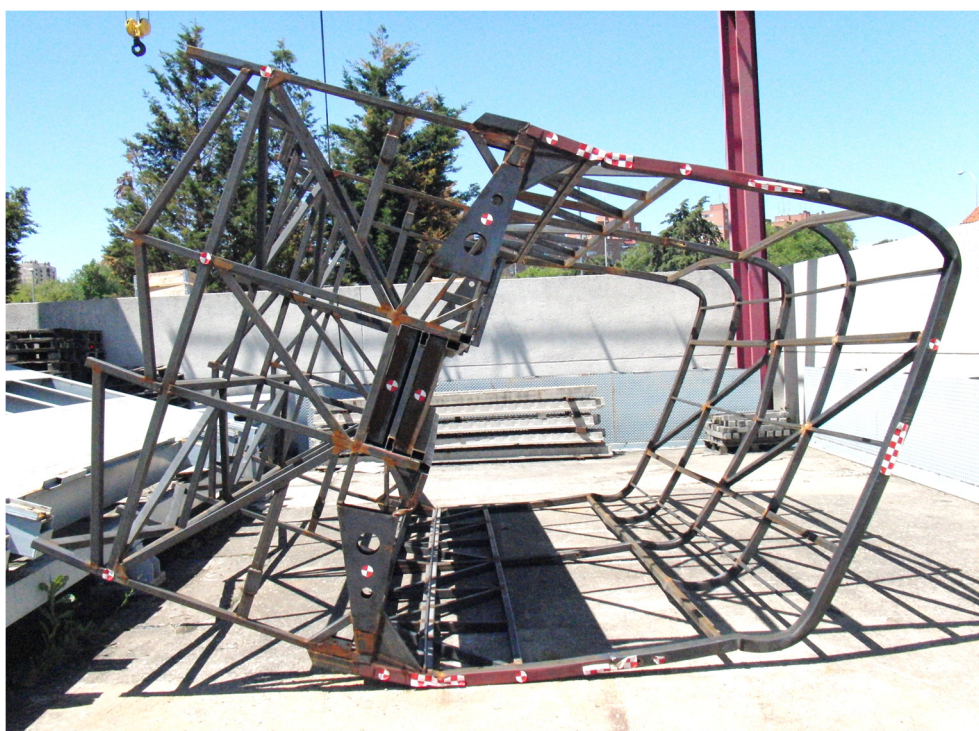
Figura 166. Estructura general en el instante final. Modelo M.E.F. y ensayo. Vuelco 2.
