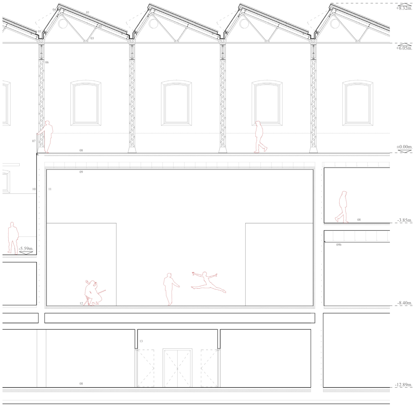
Fig. 40. Detalle Sección Long. Centro Cultural Daoíz y Velarde, Rafael de La-Hoz, Madrid, España, 2013(Fuente: Elaboración propia)
