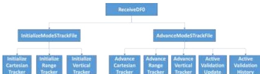
Ilustración 2. Estructura de llamadas de la lógica de estimación del intruso
