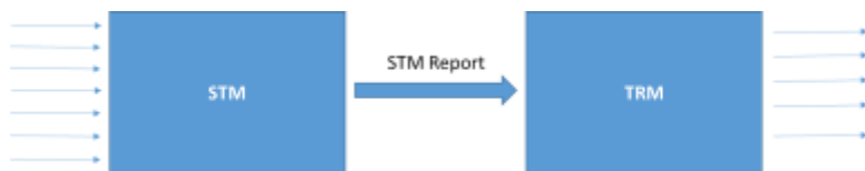
Ilustración 1. Arquitectura lógica de un sistema de evitación de colisiones
