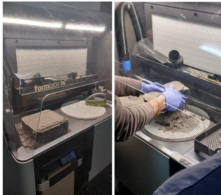
Figura 71. Posacabado de las piezas impresas en 3D en SLS.
