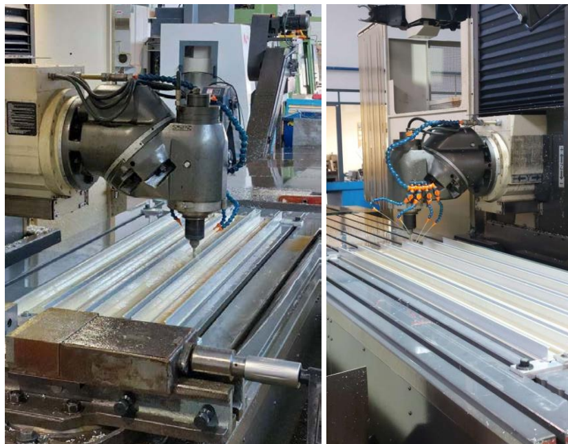
Figura 24. Mecanizado de los perfiles Minicrates en el taller del CIEMAT.
