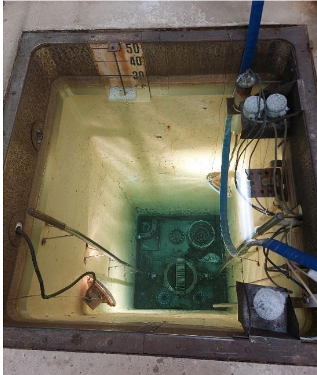
Figura 78. Vista superior de la piscina de la Instalación Náyade donde se muestra la distribución de fuentes en 6 lotes.
