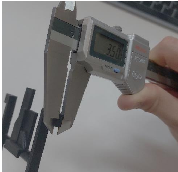
Figura 62. Medición de la altura las pestañas del fibers support.
