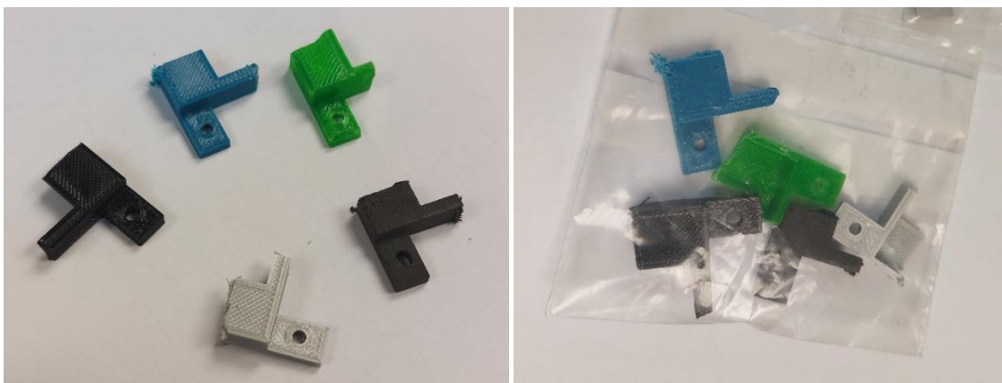
Figura 79. Recortes de piezas impresas en 3D para introducir en el portamuestras en el ensayo de irradiación.
