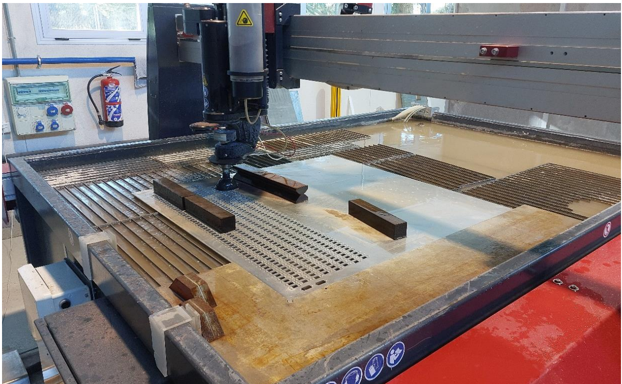
Figura 88. Fabricación por corte con chorro de agua de las piezas nut en los talleres del CIEMAT.
