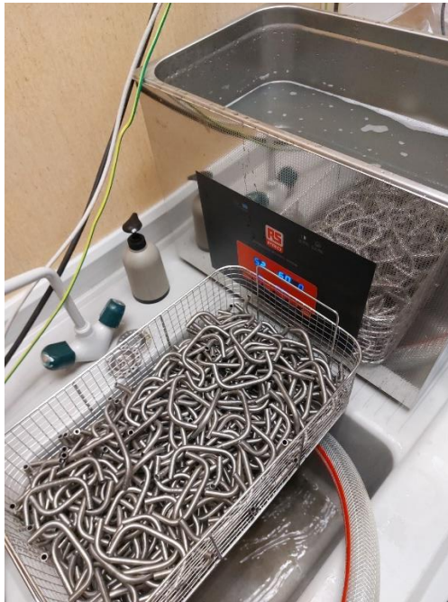
Figura 35. Extracción de las "Us" de la máquina de ultrasonidos.
