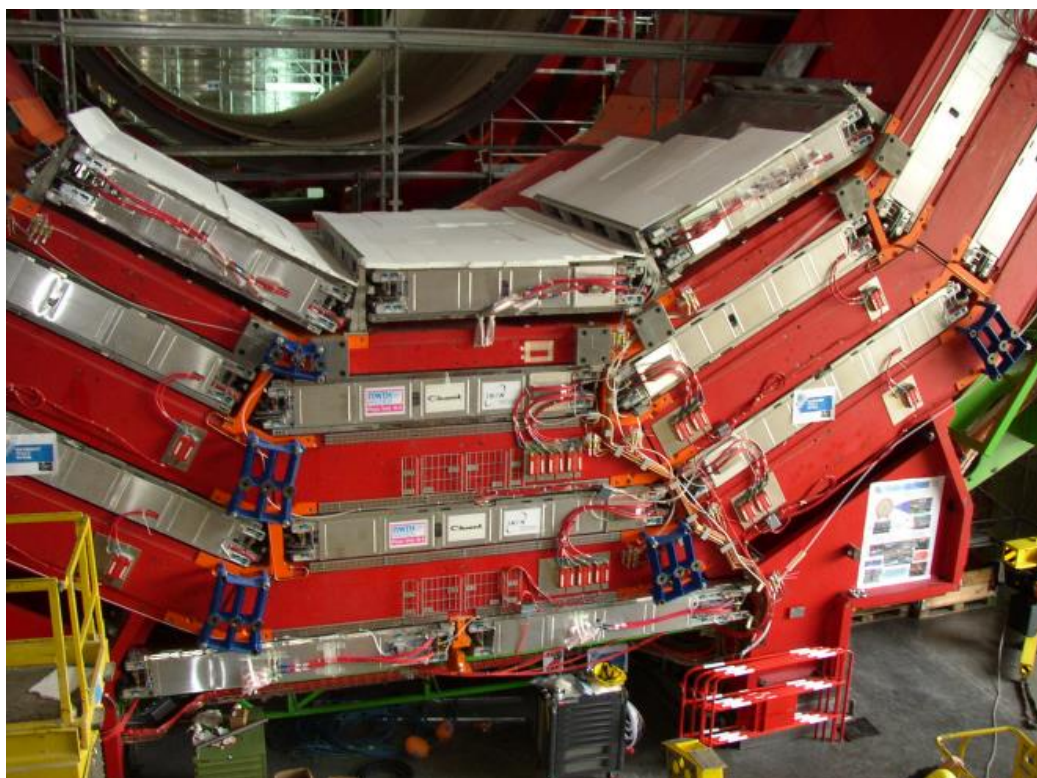
Figura 12. Fotografía de una parte del armazón de CMS con las cámaras DT. [8]
