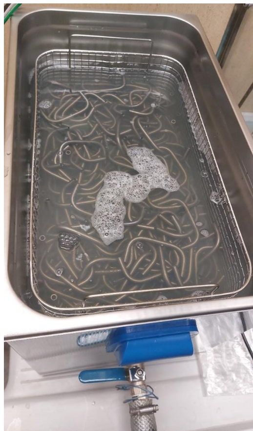
Figura 34. Máquina de ultrasonidos durante la limpieza de las "Us".
