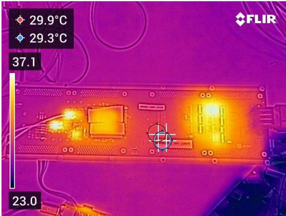
Figura 41. Imagen de la tarjeta OBDT-Theta tomada con una cámara termográfica.
