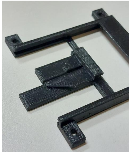
Figura 69. Prototipo de pieza impresa en 3D en Nylon.
