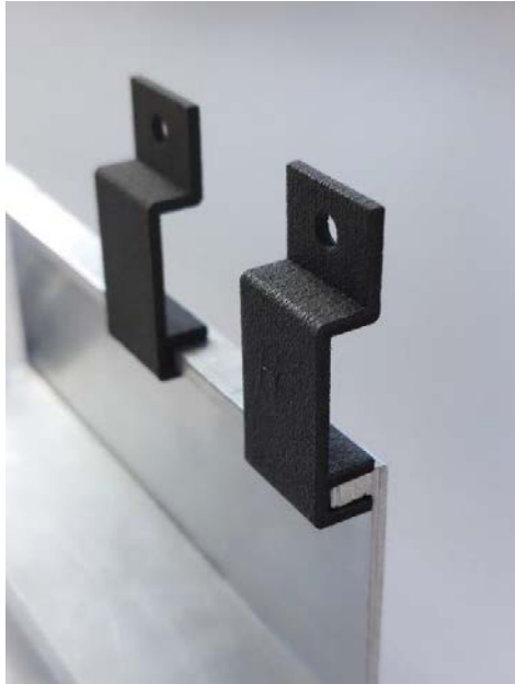
Figura 111. Prototipo en PA12 impreso en SLS de piezas de anclaje de las cubiertas de protección para los Minicrates.
