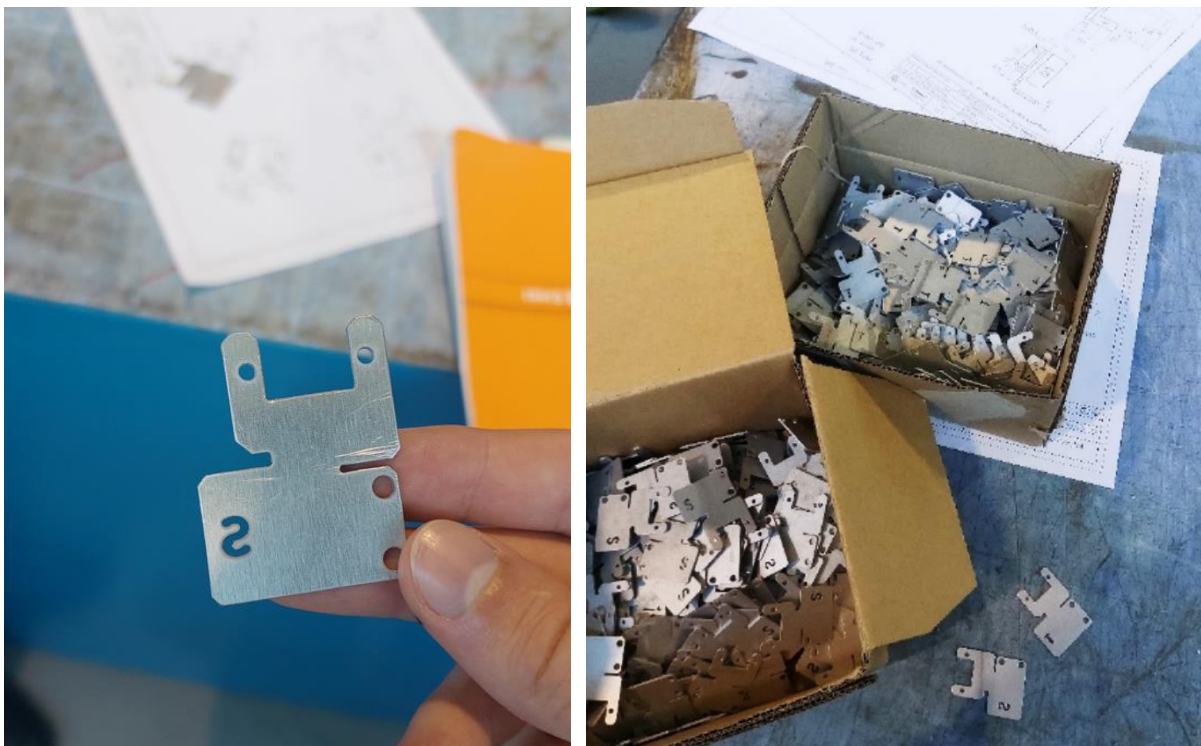
Figura 91. Corte de chapa por chorro de agua de las piezas fiber caps previo al plegado en el taller del CIEMAT.
