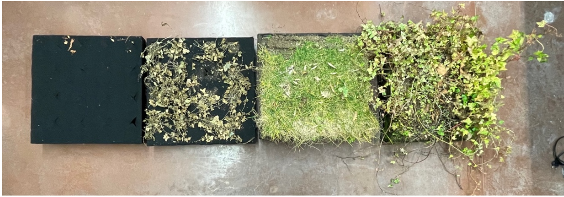
Figura 29: Módulos de jardinería vertical utilizados para las pruebas de absorción acústica en laboratorio
