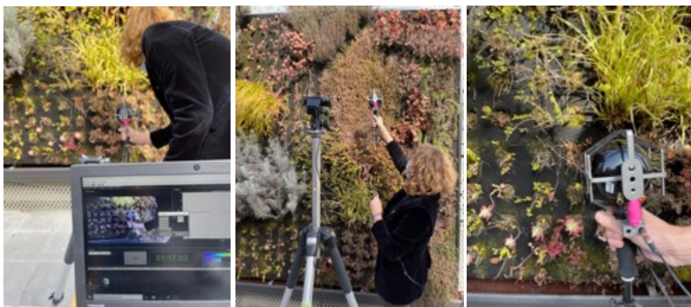
Figura 33: Técnica “Scan&Paint” utilizada para la toma de datos in-situ
