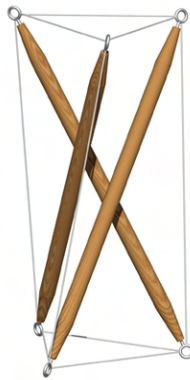
Fig 75. Diseño simple de tensegridad de tres barras [39]
