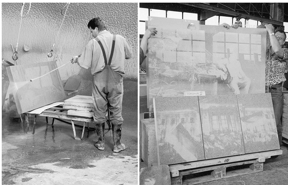
2.4.20 - 2.4.21 Técnica de impresión sobre el hormigón. Herzog & de Meuron, Eberswalde, 1993
