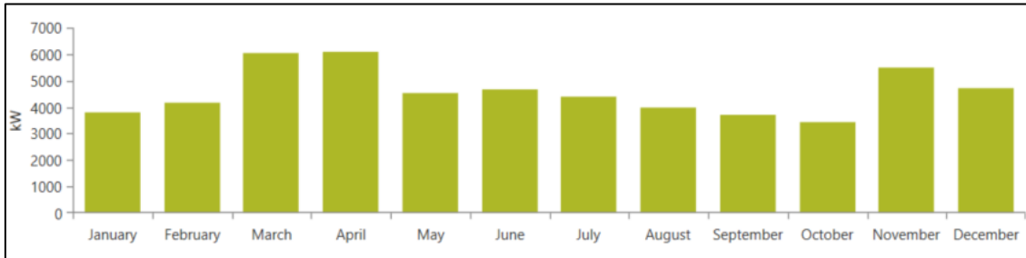
Figura 45. Perfil de producción de hidrógeno del caso final en HOMER Pro.
