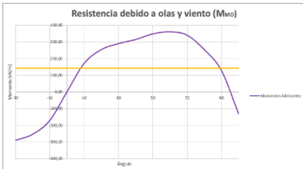
Figura D.15: Gráfico ensayo de resistencia a olas y viento para la condición M_{MO}
