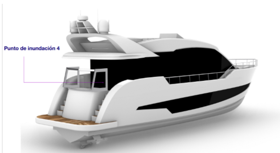
Figura 10.3: Potenciales puntos de inundación de la embarcación
