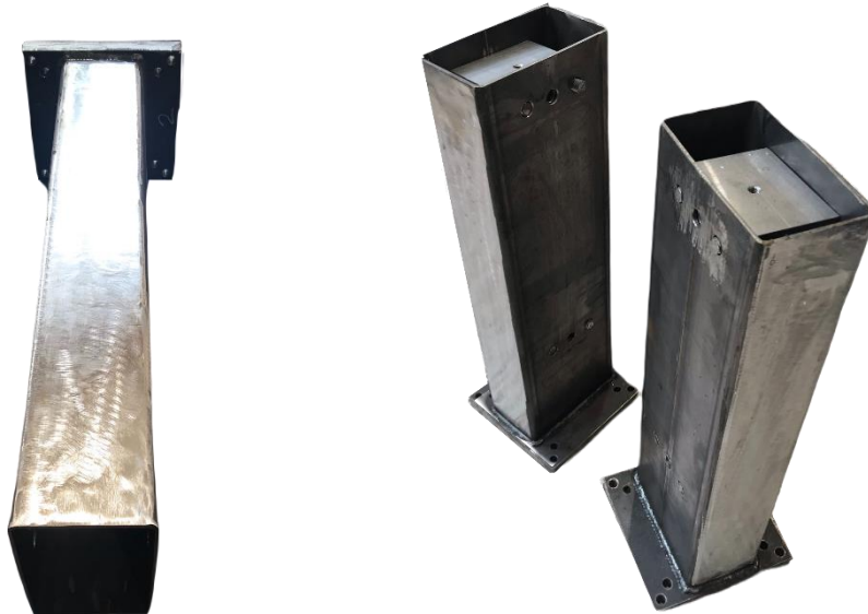
Figura 6.4: Preparación de la superficie del disipador MP-TTD.
