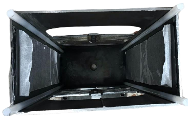
Figura 6.6: Colocación de las varillas de montaje.
