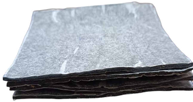
Figura 2.31: Láminas de material N3 empleadas en el ensayo dinámico.
