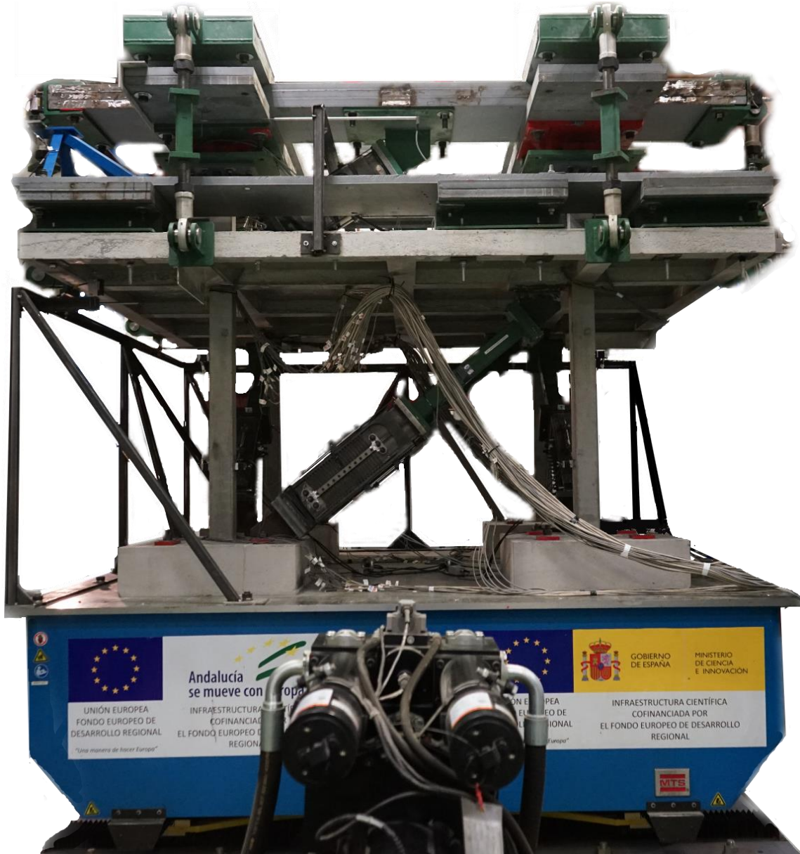
Figura 6.8: Fotografía del espécimen FVED-1 colocado en la mesa de ensayo vista desde el actuador en dirección X.
