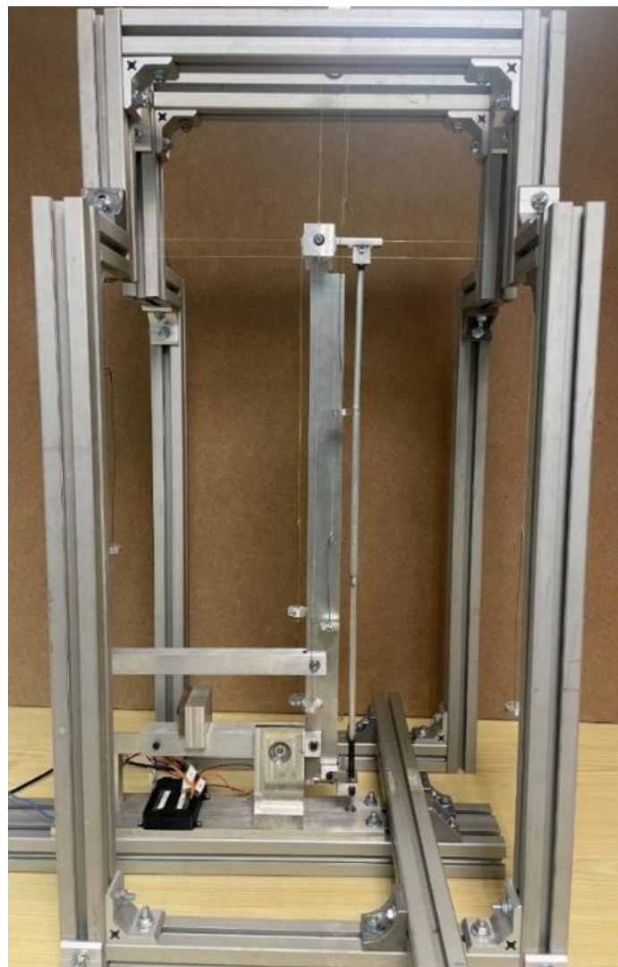
Figura 36: Soporte para posicionar las poleas durante la calibración.
