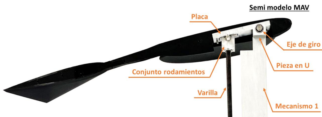
Figura 30: Vista lateral del ensamblaje de la balanza externa y el semi - modelo MAV.
