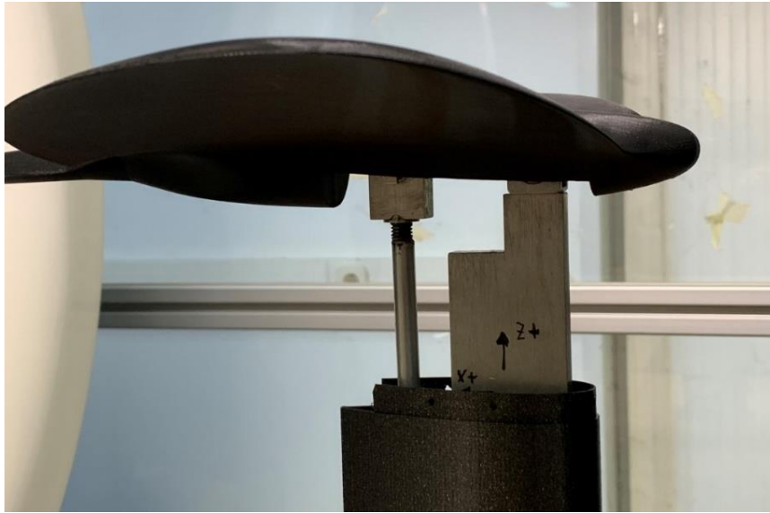
Figura 59: Detalle de la unión del modelo MAV y la balanza externa.
