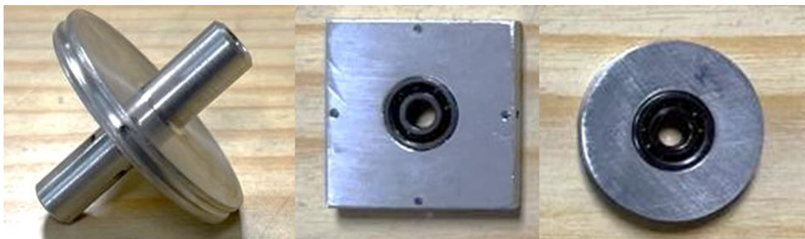
Figura 34: Piezas mecanizadas en aluminio que componen el rig de calibración (x2 piezas circulares (izquierda), x2 piezas cuadradas (centro) y x6 poleas (derecha)).
