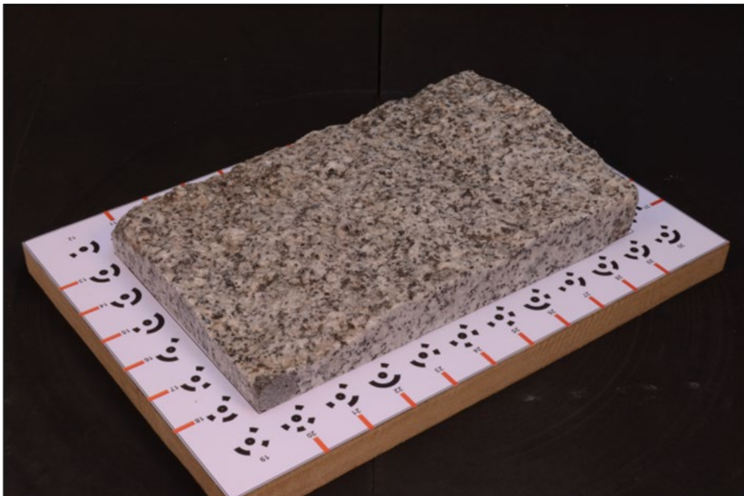
Figura 46. Imagen de ejemplo de uno de los barridos (superior) realizados en la Muestra 2: Distancia focal 38 mm; Apertura f/32 .
