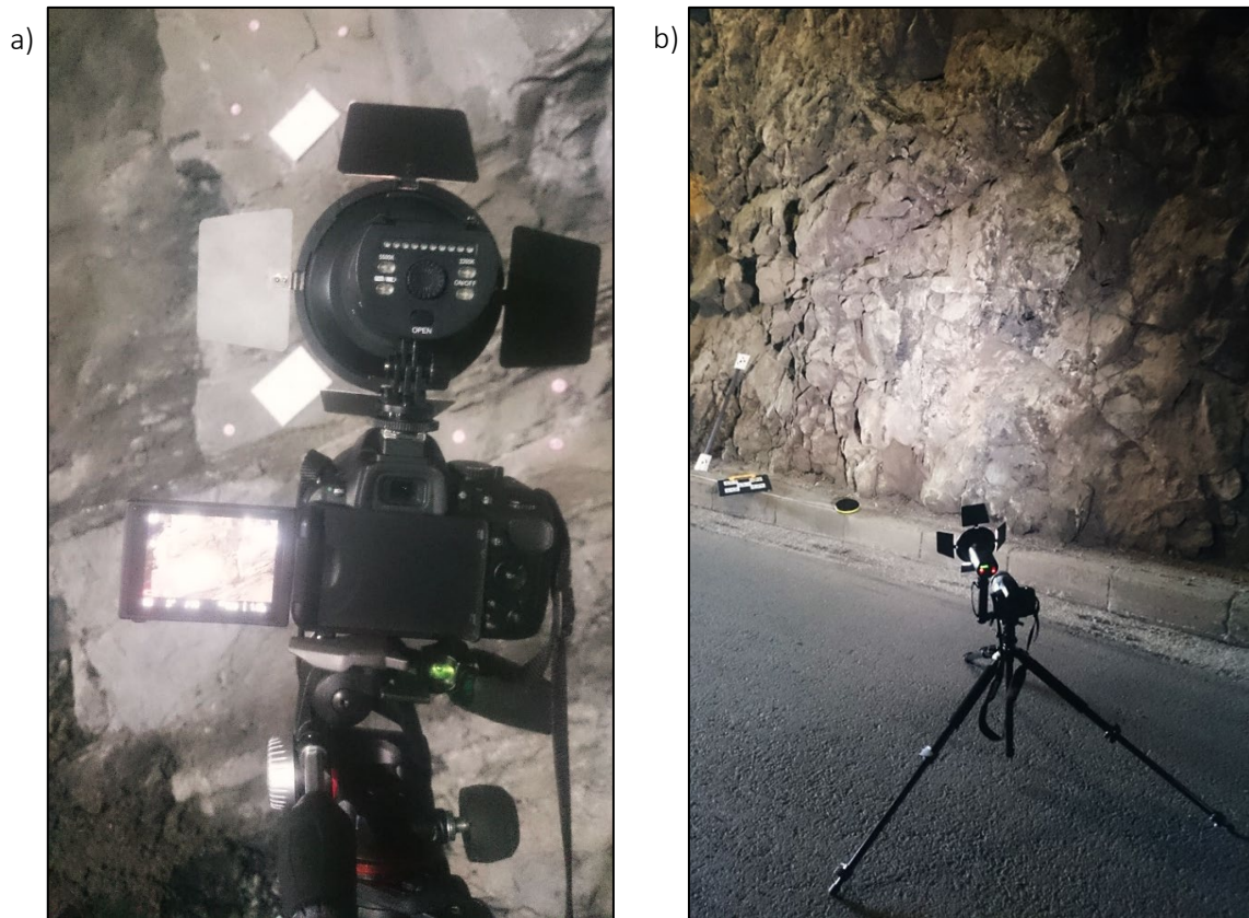
Figura 14. Configuración del equipo fotográfico empleado para la adquisición de las imágenes en los túneles: a) Detalle Antorcha LED; b) Cámara + Soporte + Antorcha + Trípode.
