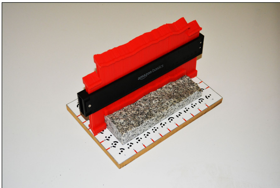
Figura 48. Imagen de la obtención de los perfiles manuales (longitudinales) adquiridos con el Peine de Barton en la Muestra 2.
