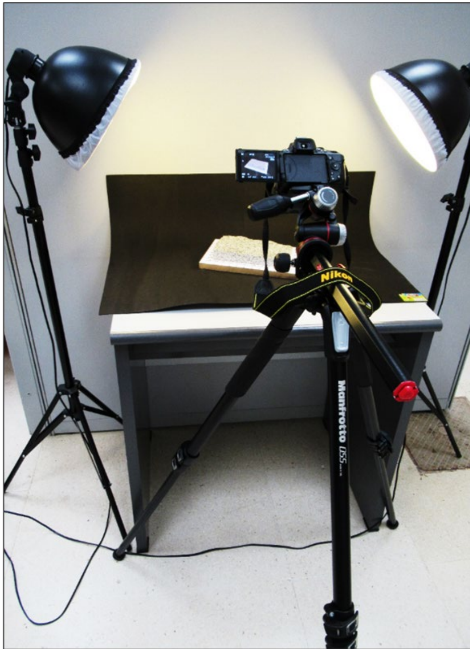
Figura 43. Set de fotografía macro empleado para la adquisición de las fotografías.
