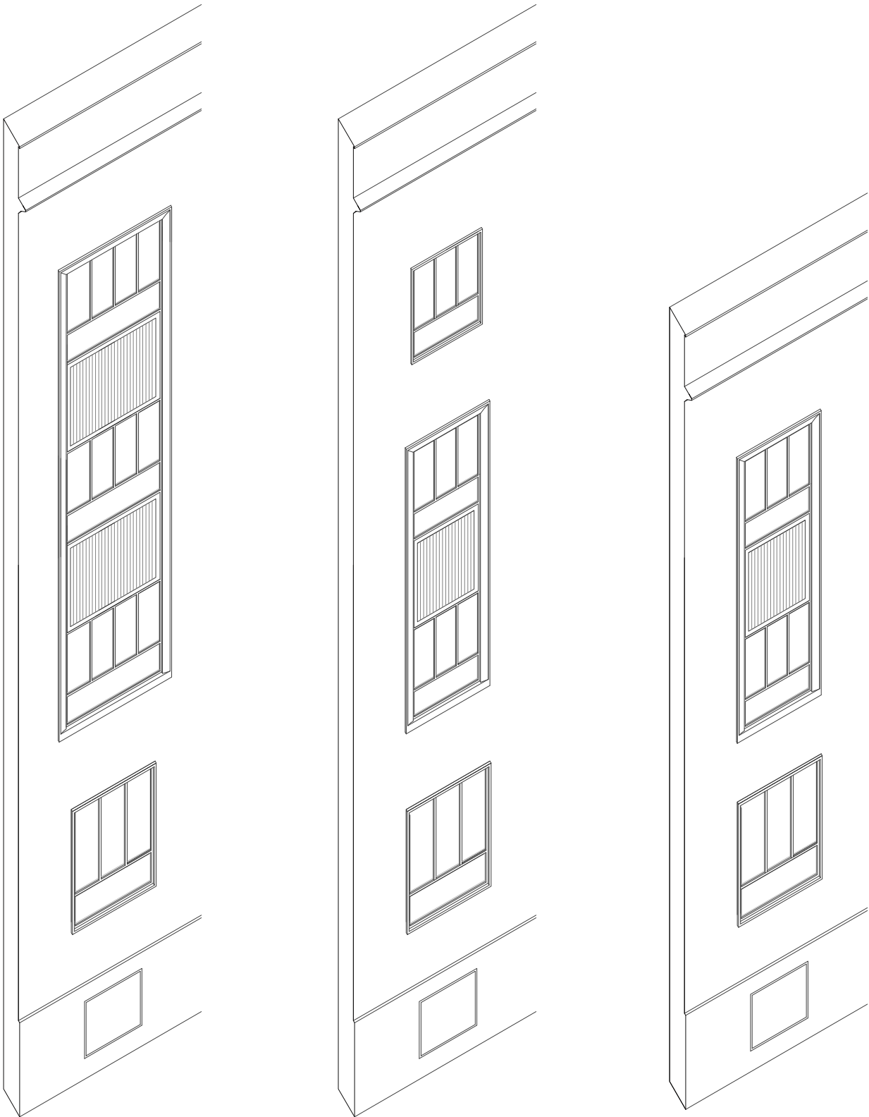
Facultad de Farmacia. Módulos de fachada. Axonométrica.
