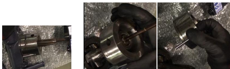
Figura 136: 10 despiece: Primer subconjunto compuesto de cuerpo pistón, trinquete, barra rotación, muelle trinquete y pivote trinquete. Segundo subconjunto compuesto de espiga corona, corona, válvula perforada, casquillo válvula y cuerpo válvula
