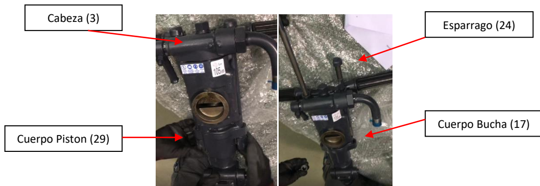
Figura 130: 4 despiece: cabeza, cuerpo bucha, cuerpo pistón, tuerca esparrago
