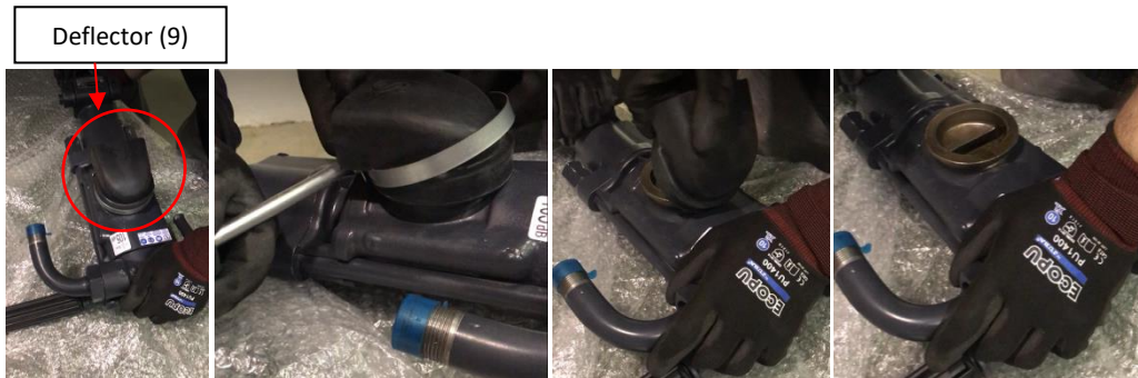
Figura 128: 2 despiece: cabeza, cuerpo bucha, cuerpo pistón, retenedor cuadrado, deflector
