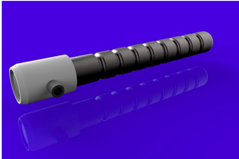
Figura 113: Unión entre el vástago, el casquillo y el pasador elástico
