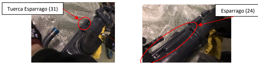
Figura 127: 1 despiece: Tuerca esparrago y espárrago
