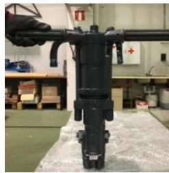
Figura 23: Imagen real y física del martillo neumático rotopercutor MS76 de Segeda
