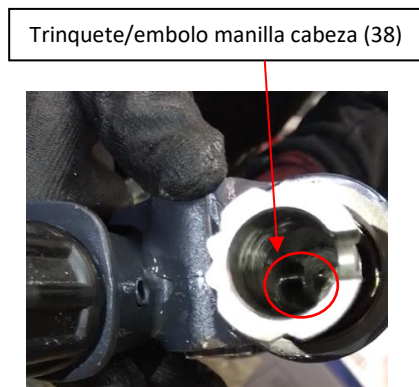
Figura 152: Detalle trinquete/embolo manilla cabeza
