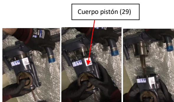
Figura 135: 9 despiece: cuerpo intermedio y cuerpo pistón
