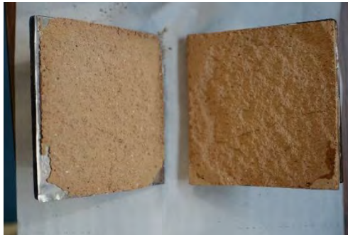
C_{A30(1)} : Fallo intermedio en un 70% adhesivo y un 30% cohesivo.
