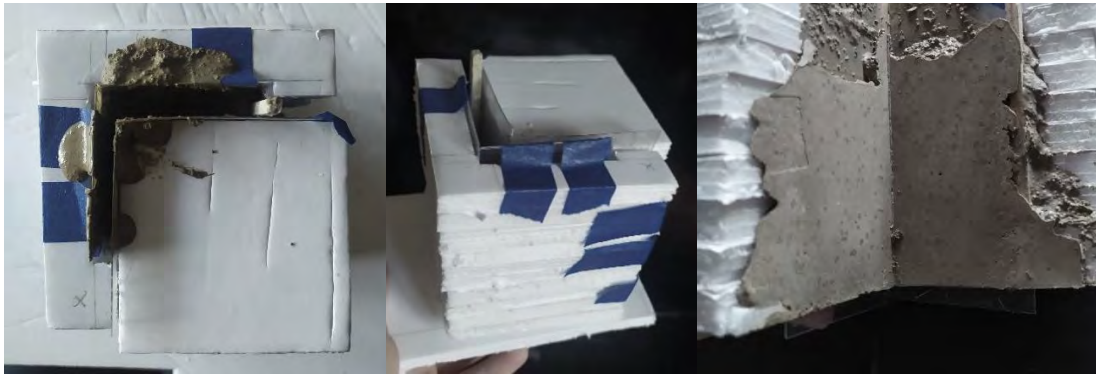
Ilustración 22. Segundo encofrado esquina 90°.
