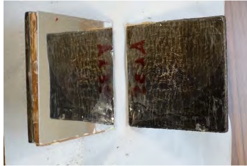
C_{A30(1)} : Fallo intermedio en un 70% adhesivo y un 30% cohesivo.
