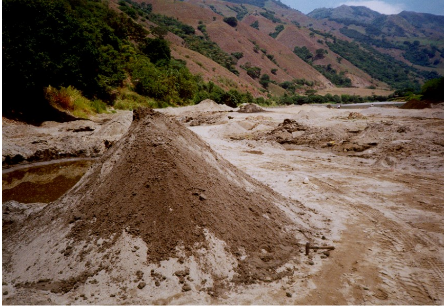
Figura 40. Extracción de arena fina utilizada en mampostería. Aluvión del río Cauca, sector de Bolombolo. Fotografía: el autor.
