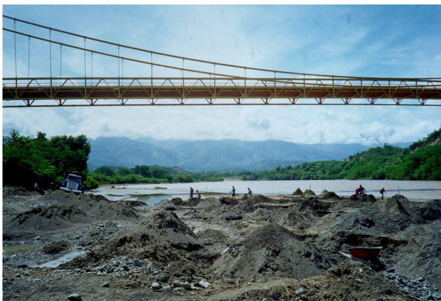
Figura 18. Extracción de arena y grava en la desembocadura del río Tonusco al río Cauca.
