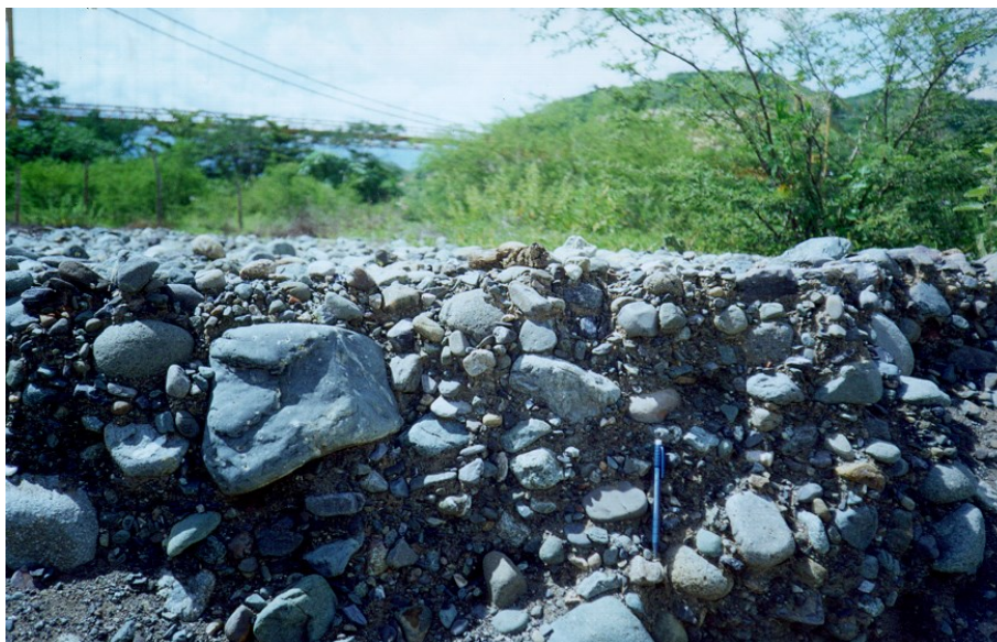
Figura 23. Perfil de un aluvión en la quebrada Aburrá, afluente del río Cauca. Material arena y grava. Fotografía: el autor.
