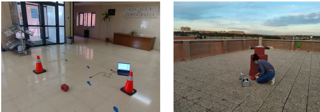
Figura 39. Imagen de la campaña de campo de medidas de vibración ambiental utilizando un sensor de velocidad portátil 3D Tromino.
