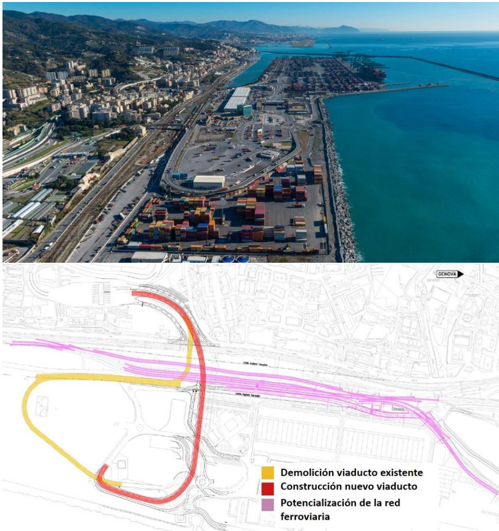
Figura 6.25: Obras de reorganización de la accesibilidad intermodal Puerto Génova Prà L11 – P.2729.
