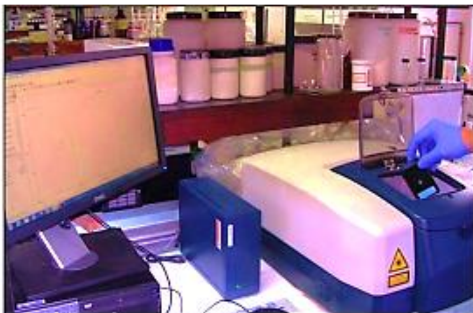
Espectrofotómetro FTIR: caracterización de vehículos, disolventes, etc. Laboratorio QUÍMICA I de ETS Ingenieros Industriales (UPM)
