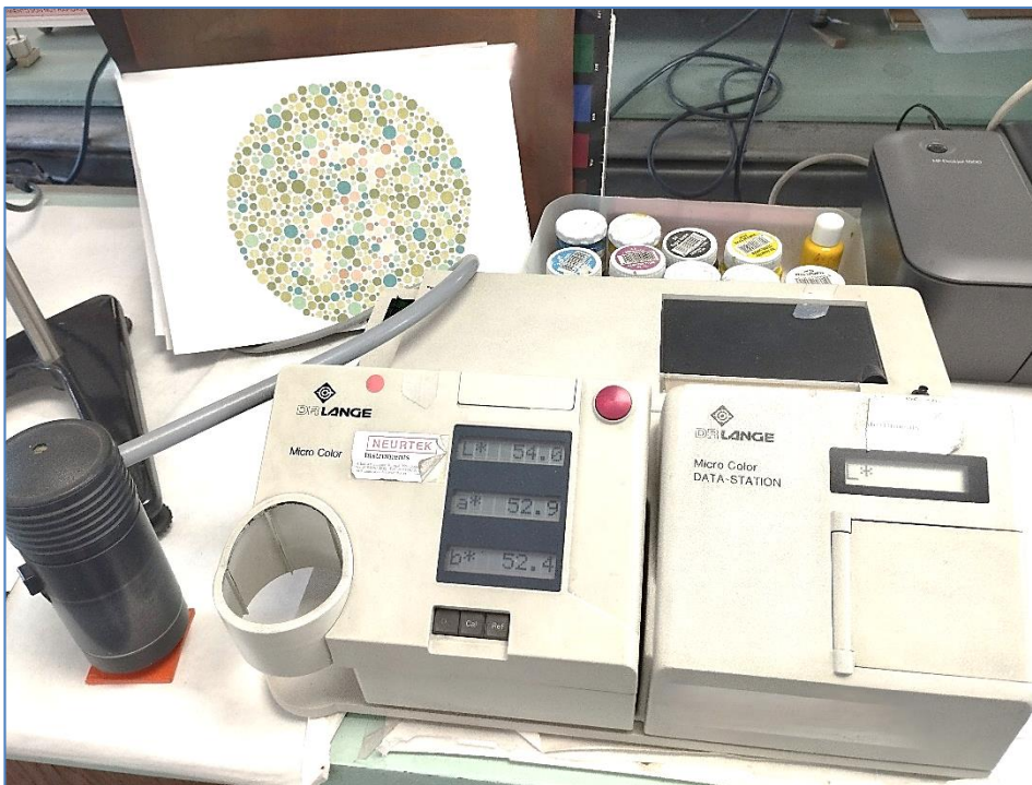
Colorímetro triestímulos, medida de un zócalo rojo. ETSII (UPM)
