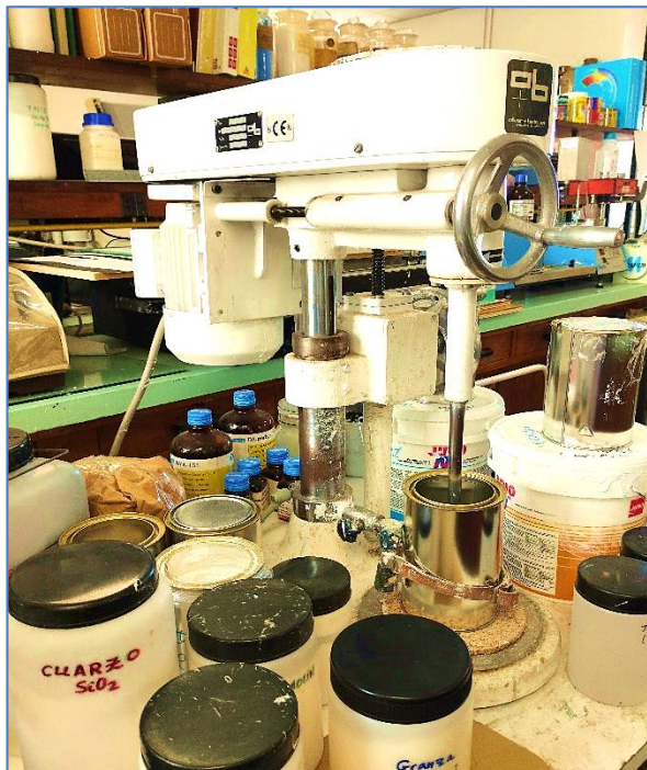
Mezcladora de laboratorio "tipo dispermix" para fabricación de pinturas.
