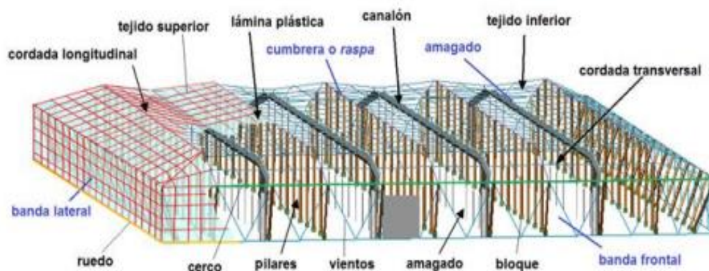
Figura 6. Invernadero tipo raspa y amagado (Fuente: Centro de Investigación en Agrosistemas Intensivos Mediterráneos y Biotecnología)
