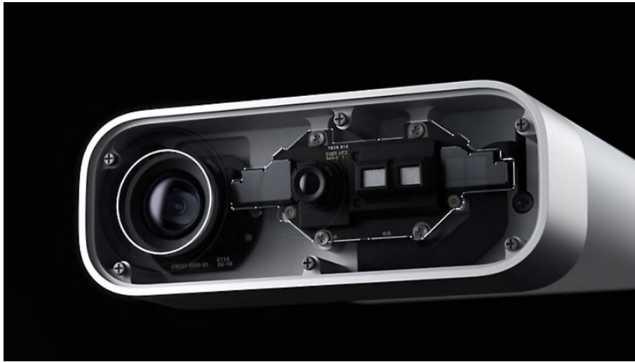
Figura 8: Cámara Azure Kinect y sus sensores [9]
