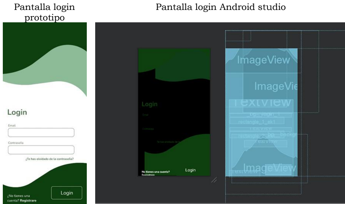
Ilustración 17: Pantalla login en el prototipo y el "Layout Editor" de Android Studio
