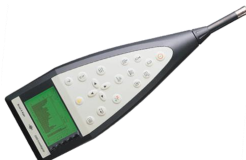
Ilustración 8. Sonómetro Brüel & Kjaer 2260. [9]
