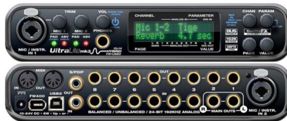
Ilustración 10. Interfaz de Audio MOTU Ultra Lite MK3. [11]
