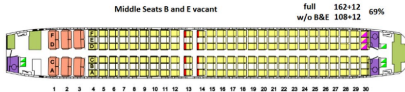
Figura 2.7: Distribución Habitual de un Boeing 737 [6]
