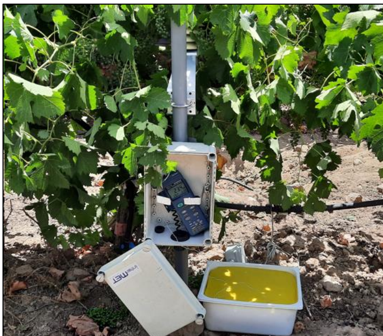
Figura 3.1.2. Estación meteorológica portátil situada dentro del seto, midiendo la temperatura del aire. Incluye un datalogger y un termopar conectado a una referencia artificial húmeda (RAH) compuesta por una bayeta amarilla constantemente húmeda.
