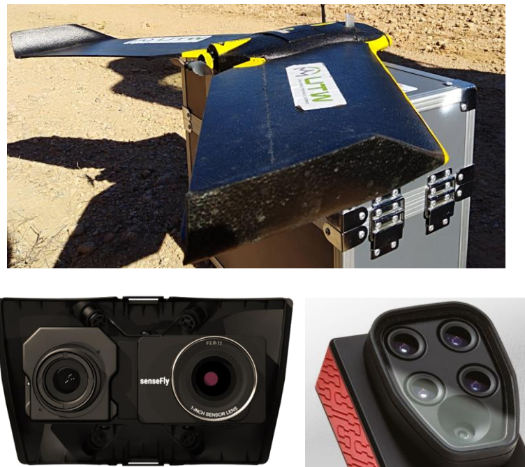
Figura 3.2.1. Imagen Superior: Plataforma UAS de ala fija. Imagen inferior izquierda: cámara térmica Duet-T (AgEagle, 2022). Imagen inferior derecha: Sensor multiespectral Parrot Sequoia (Parrot, 2021)
