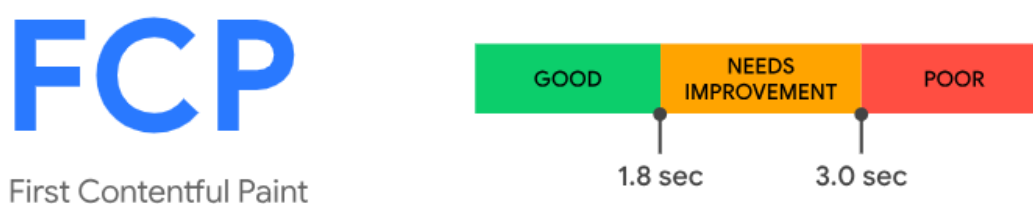
Ilustración 8. Un valor adecuado para el FCP es 1.8 o inferior. Fuente: (web.dev, 2024)
