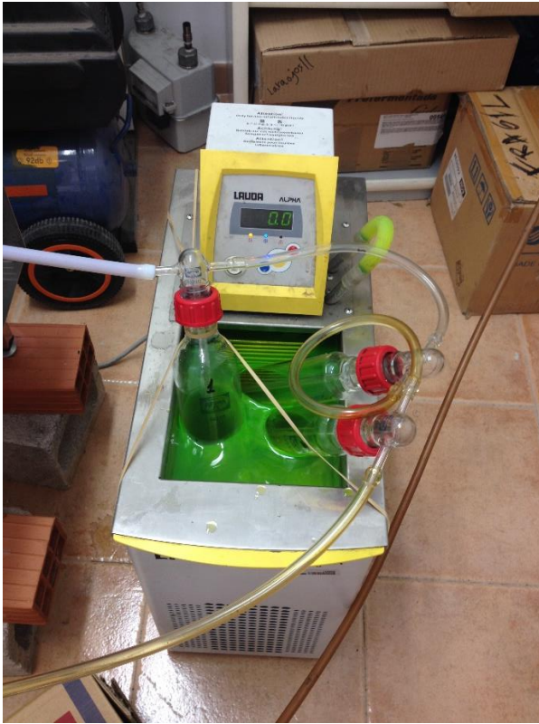
Ilustración 36. Baño de refrigeración para los matraces de condensación de gases
