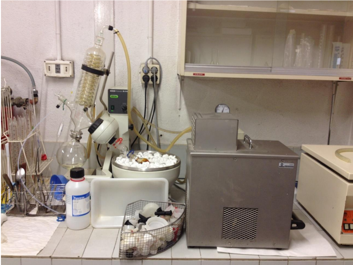
Ilustración 48. Rotavapor para la extracción y recuperación de dietil éter
