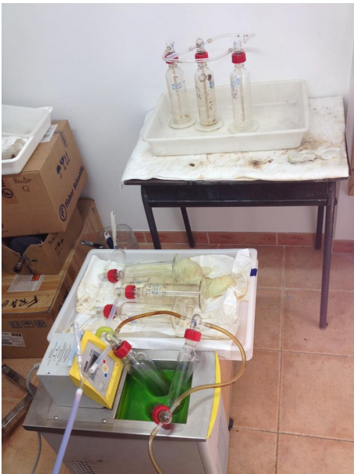
Ilustración 37. Trenes de condensadores para pirólisis fraccionada
