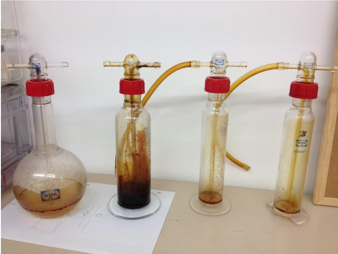
Ilustración 40. Matracas del tren de condensación tras la pirólisis
