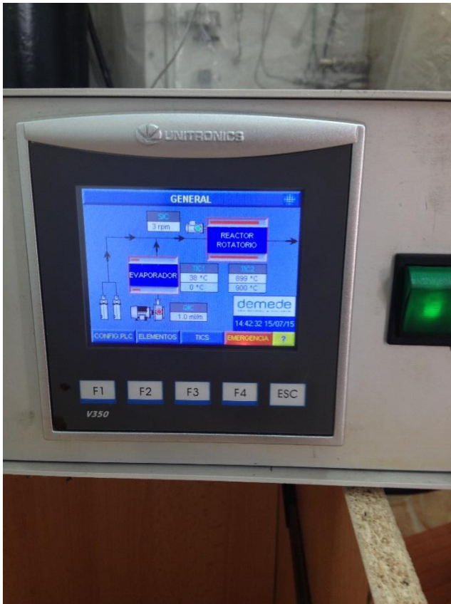
Ilustración 30. interfaz de control para la programación de rampas de calentamiento
