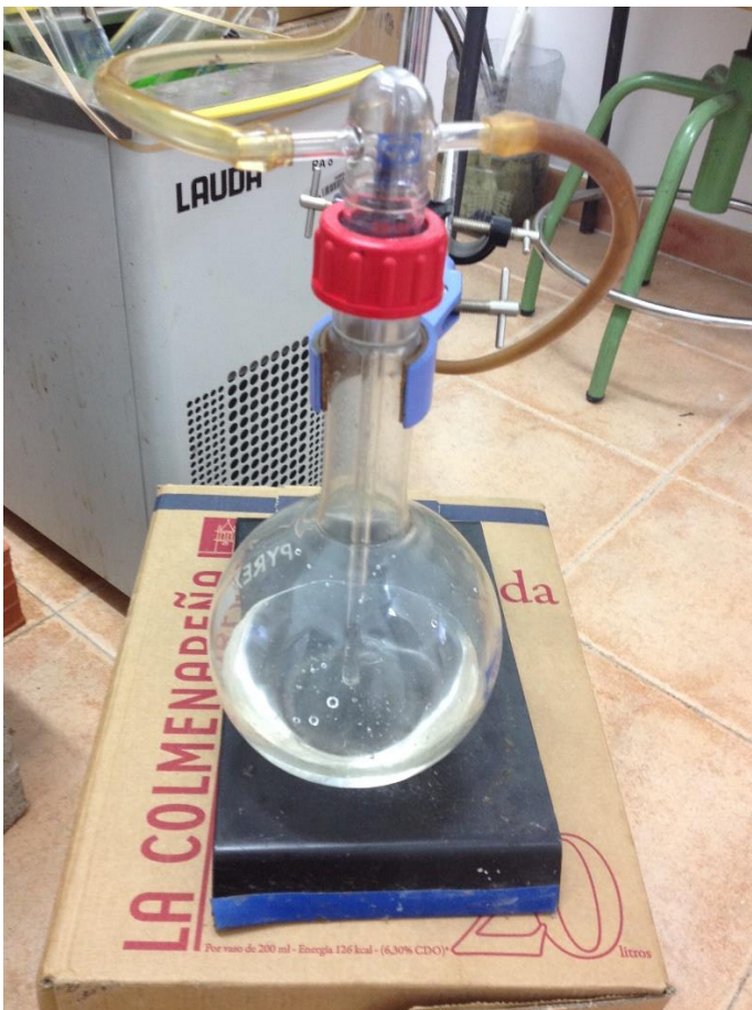
Ilustración 39. Matraz de control de borboteo
