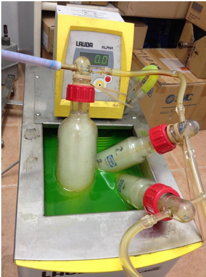
Ilustración 42. Condensación de gases en los matraces en el baño de refrigeración
