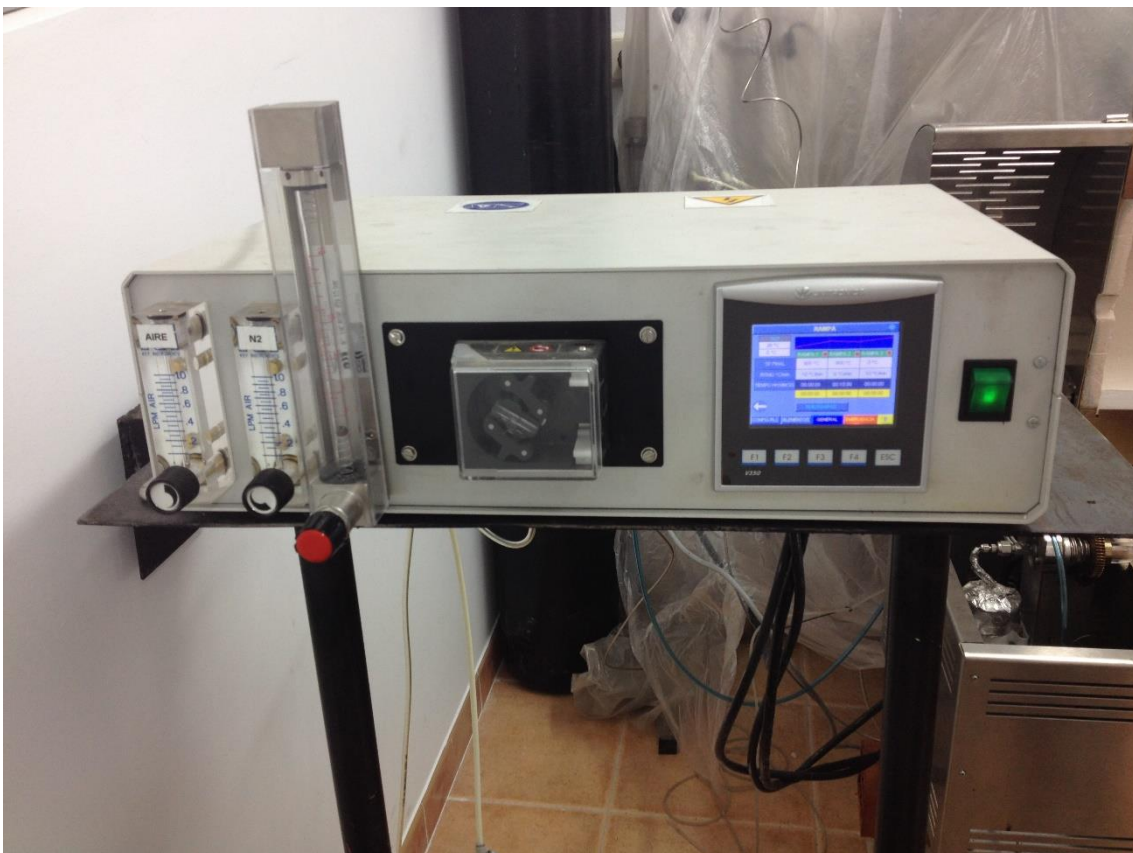
Ilustración 29. Sistema integrado de control automático PID
