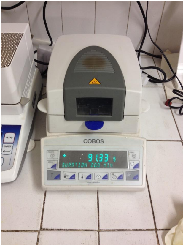
Ilustración 24. Termobalanza para la determinación de humedad de la materia prima
