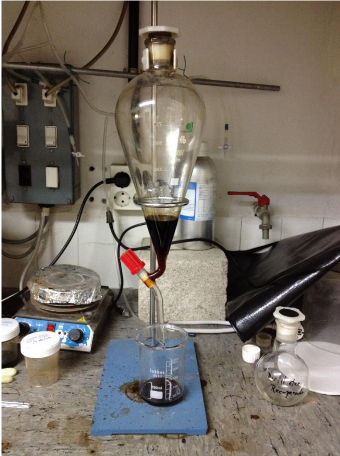
Ilustración 44. Embudo de decantación para separación de fases
