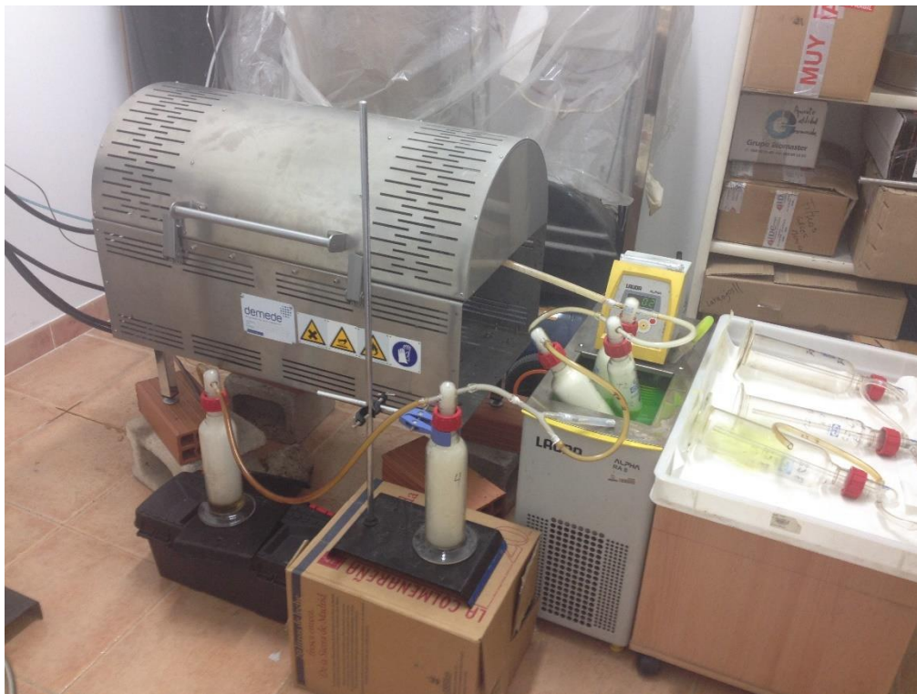
Ilustración 43. Cambio de tren de condensación
