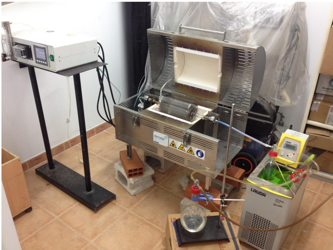
Ilustración 21. Componentes del sistema de reactor rotatorio de pirólisis
