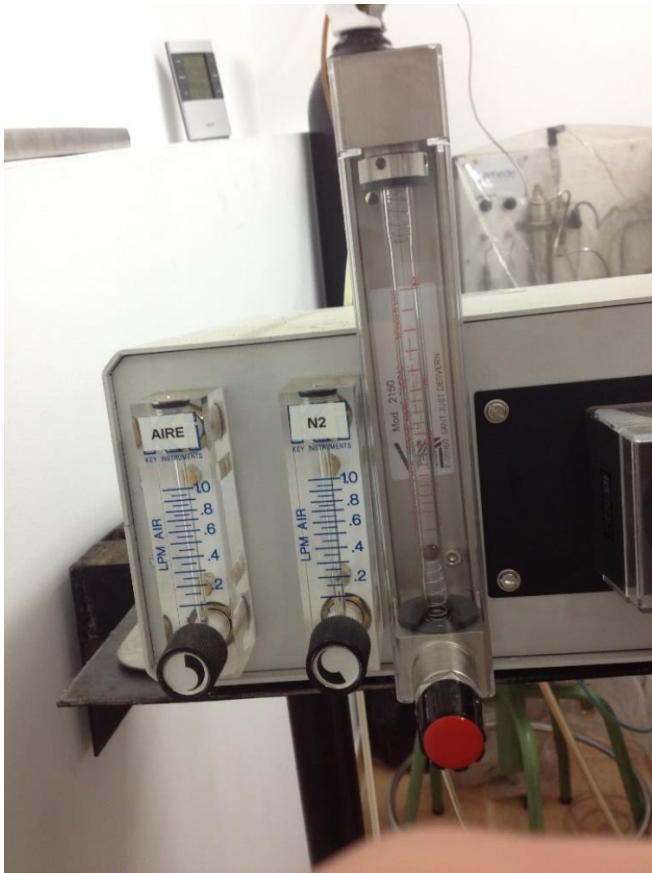
Ilustración 32. Manómetros de control del flujo de nitrógeno
