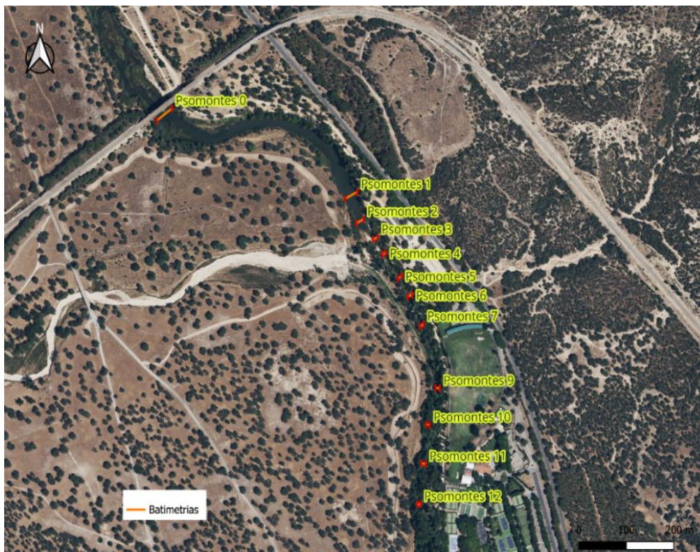
Ilustración 8. Ubicación de las secciones correspondientes a las batimetrías realizadas en julio de 2022 por la empresa TRAGSA.
