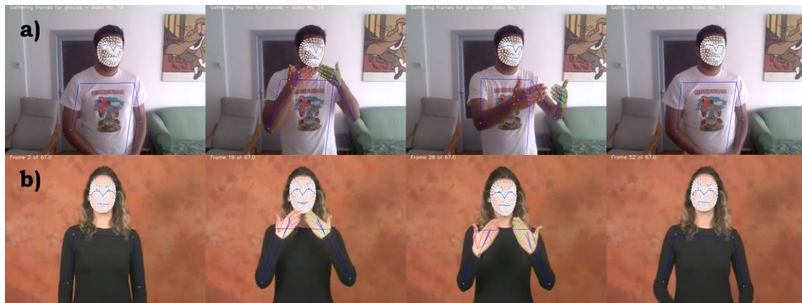
Ilustración 26 Representación visual de los puntos de interés obtenidos con MediaPipe para la expresión “gracias” de a) los videos capturados desde la cámara web y b) los videos descargados de internet.
