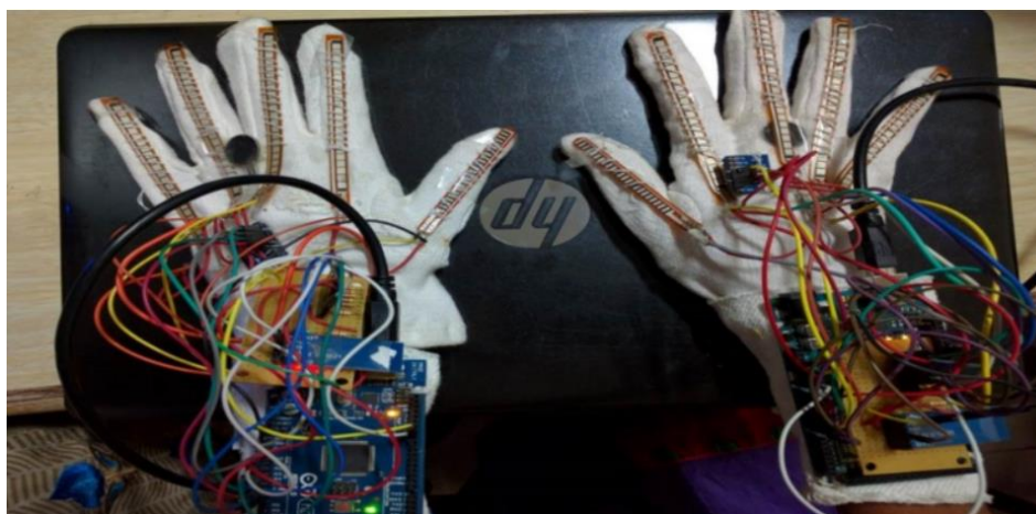
Ilustración 16 Configuración de hardware instalado en los guantes para la detección de lengua de signos india, tomado de Jeyasheeli & Indumathi (2021).
