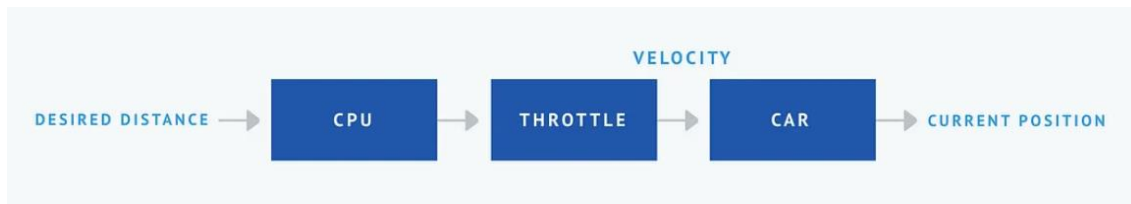
Figura 16: Funcionamiento del PID
