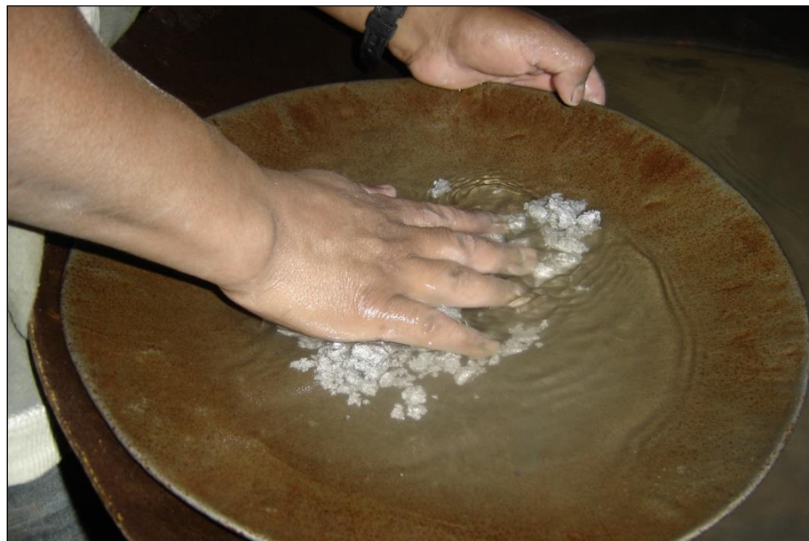
Figura 28. Limpieza y lavado de la amalgama
