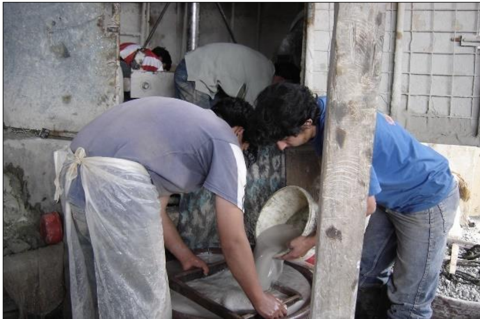
Figura 22. Recuperación y concentración de la amalgama (cernido)
