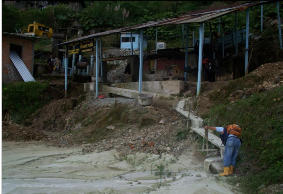
Figura 16. Planta de beneficio en el C. Norte, con un sistema de descarga directa de relaves
