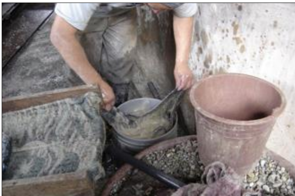
Figura 19. Lavado de bayetas, previa concentración
