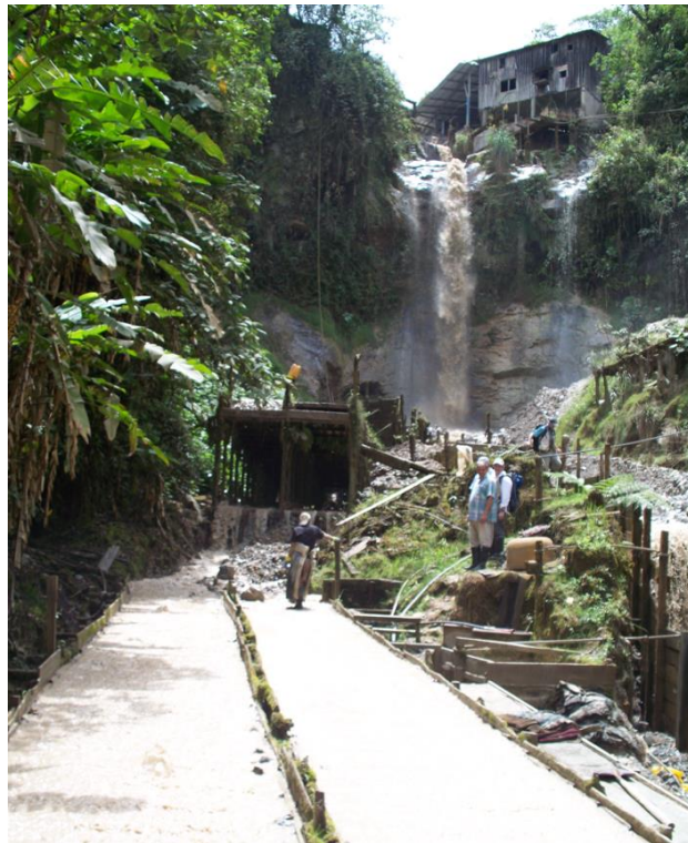
Figura 62. Canalones dispuestos en el sector "La Soledad", quebrada del Fierro
