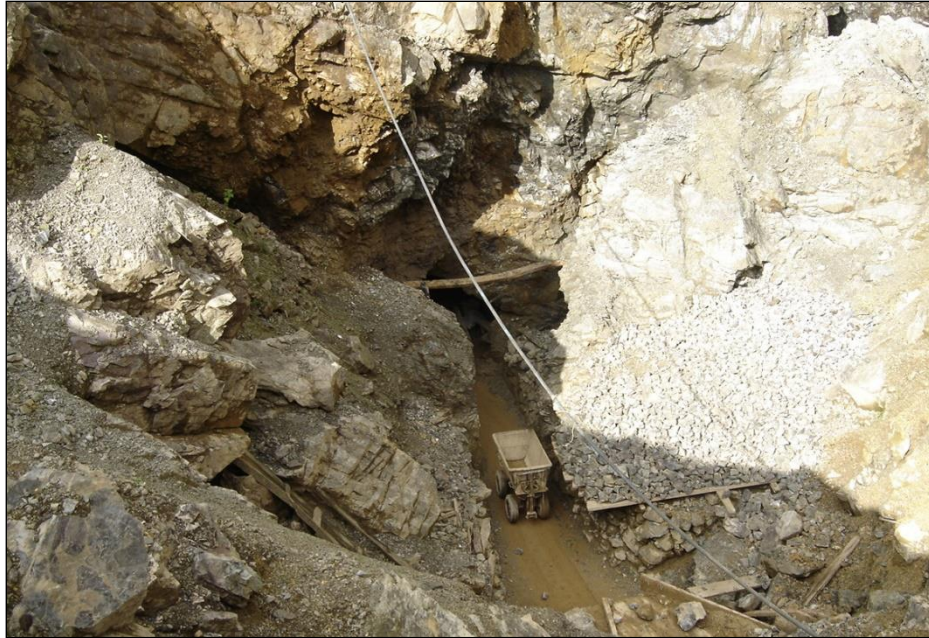
Figura 12. Vagón minero “burra” (minería subterránea)
