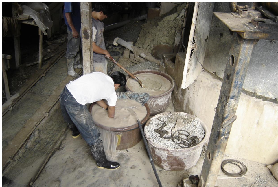
Figura 23. Baldeado (concentración por densidad)
