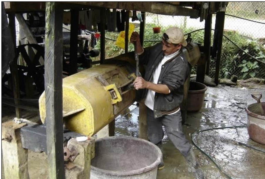
Figura 35. Molino de barras (chancha)
