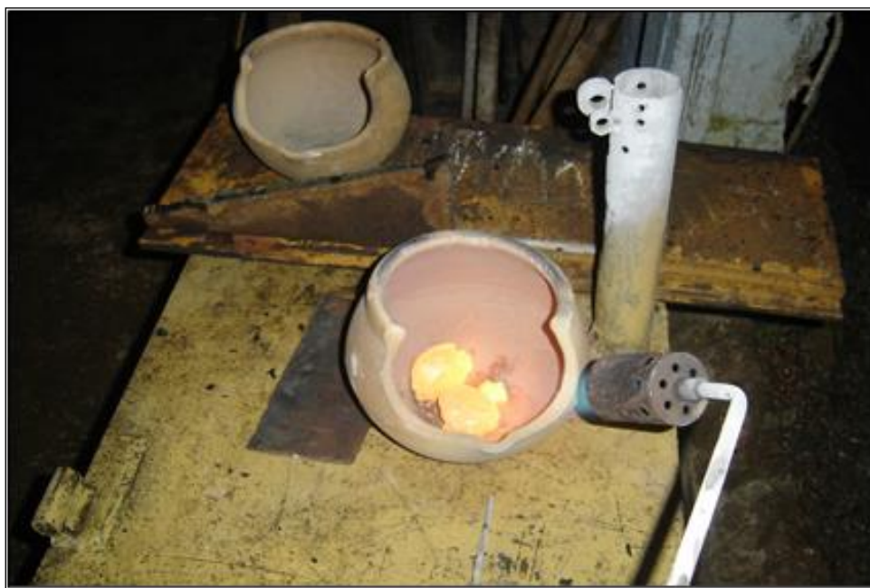
Figura 31. Quemado final (refinado)
