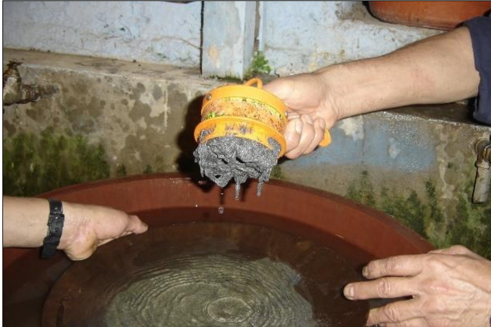
Figura 26. Eliminación de remanentes de hierro (imán)
