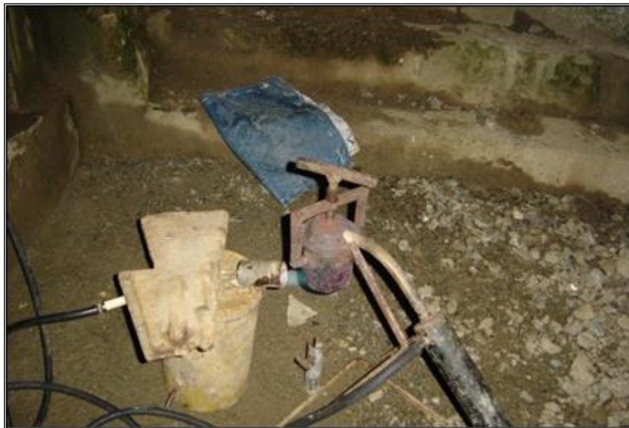
Figura 30. Quemado de la amalgama en la retorta (separación Au-Hg)
