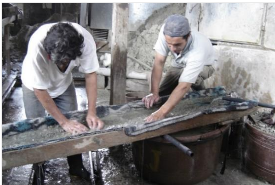
Figura 51. Laboreo tradicional, recuperación de amalgama y mercurio de relaves
