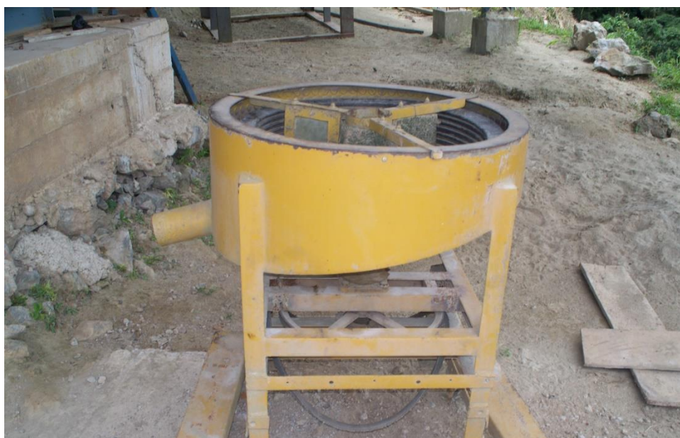
Figura 24. Concentrador centrífugo genérico (concentración por densidad)
