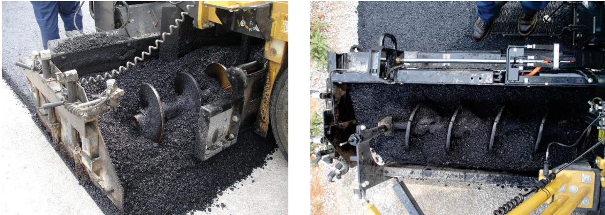
Figura 2.12: Tractor – Sinfín de Distribución
