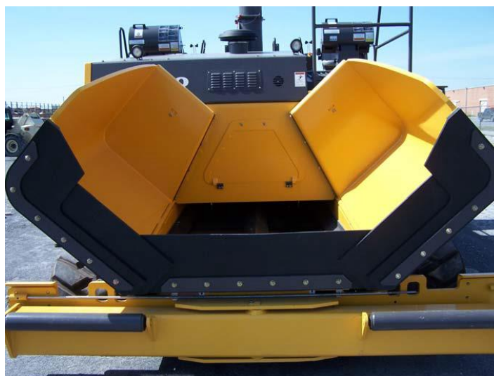
Figura 2.8: Tractor – Tolva Basculante
