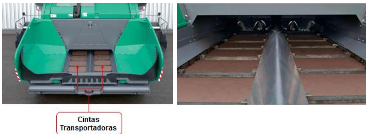
Figura 2.10: Tractor – Cintas transportadoras
