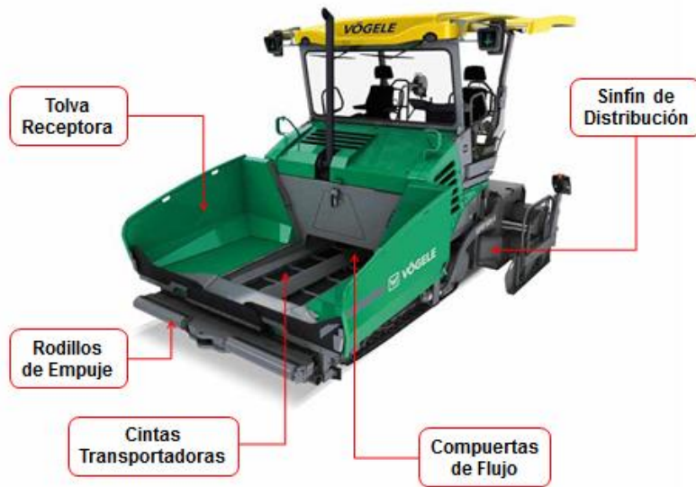
Figura 2.6: Tractor – Componentes Principales
