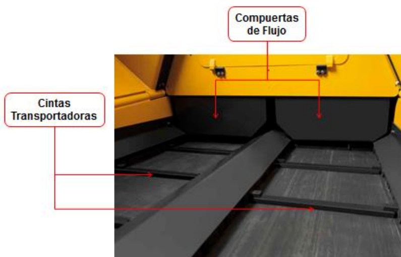
Figura 2.11: Tractor – Cintas transportadoras y Compuertas de Flujo
