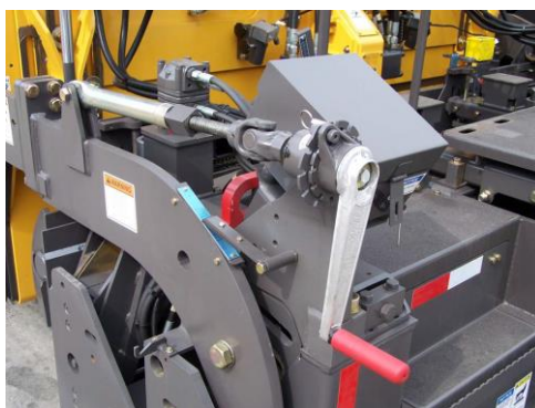
Figura 2.27: Regla de Extendido – Manivelas de Profundidad
