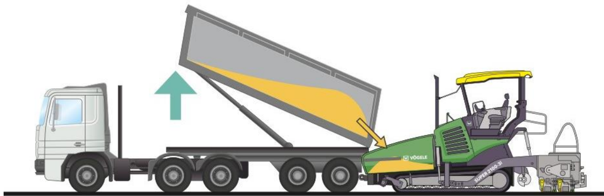
Figura 2.9: Pavimentadora – Alimentación desde el Camión
