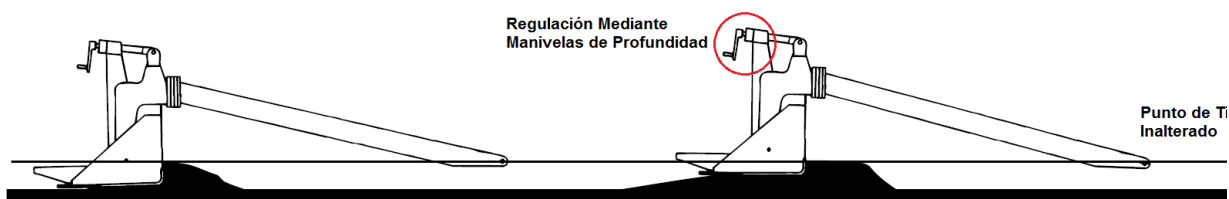
(a) Regulación por Manivelas de Profundidad
