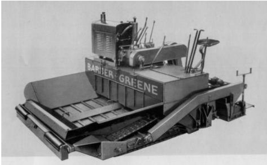
Figura 2.4: Pavimentadora Barber-Greene – Modelo 879 (año 1936)
