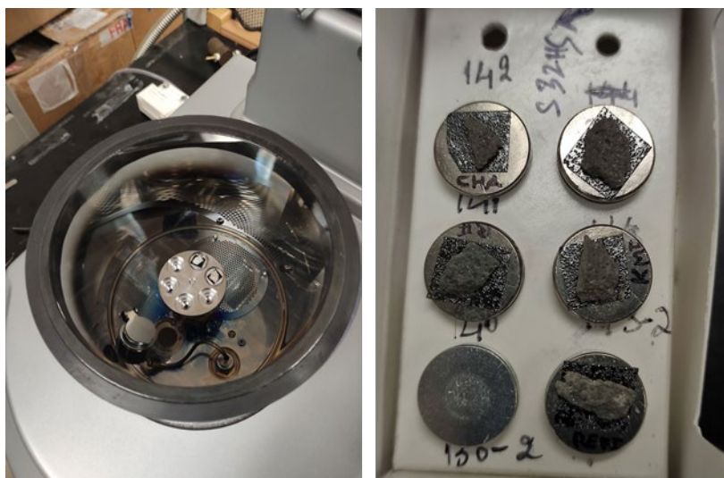
Figura 4.1 Ejemplo de recubrimiento de muestras para su caracterización con microscopía electrónica de barrido.
