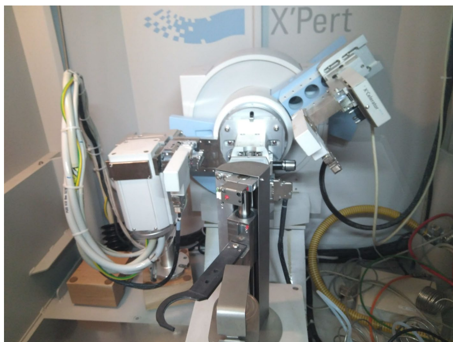
Figura 4.5 Interior de un equipo de difracción de rayos X (Instituto de Catálisis y Petroleoquímica, CSIC).
