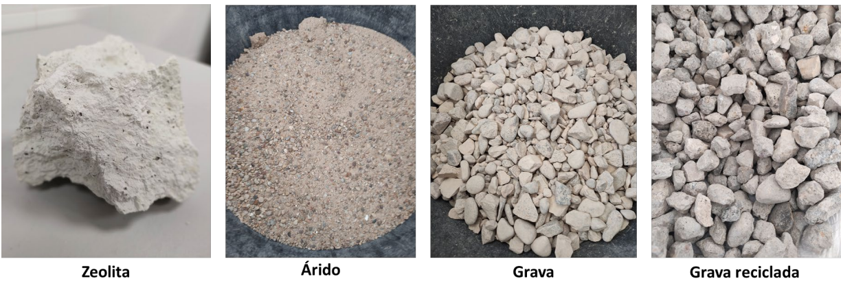
Figura 5.57 Materiales utilizados en la elaboración de probetas de hormigón.
