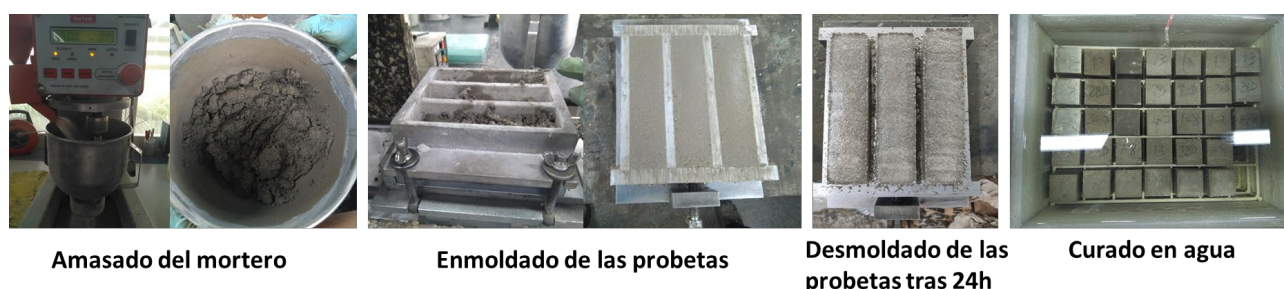
Figura 4.8 Elaboración de probetas de mortero según norma UNE-EN 196-1:2018.
