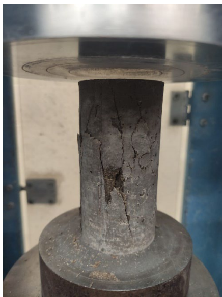
Figura 5.44 Muestra cilíndrica en un prensa de resistencia a compresión uniaxial. Para realizar el SIP se colocaron las probetas sobre los soportes diseñados y se conectaron al equipo realizando mediciones continuas hasta la edad de rotura.
