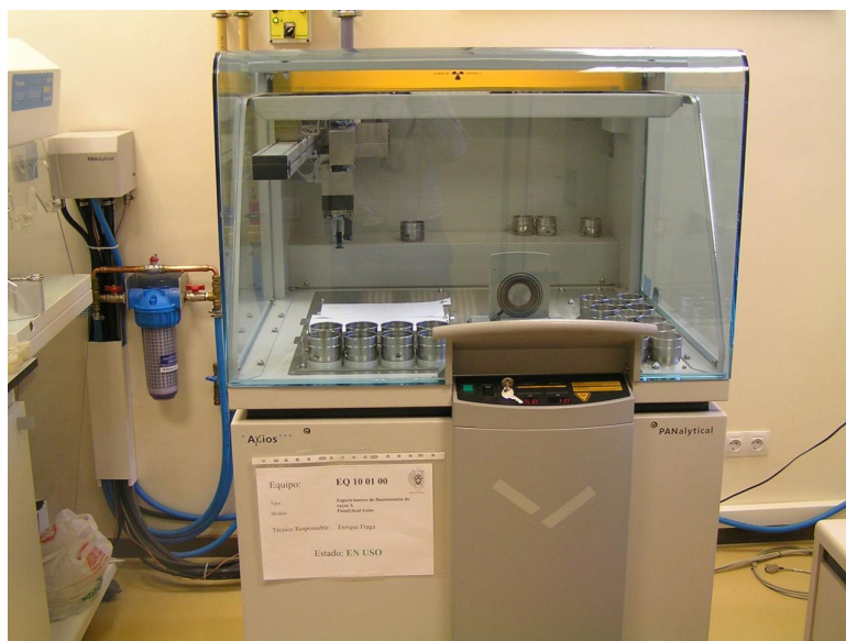
Figura 4.6 Equipo de fluorescencia de rayos X (CAI Técnicas Químicas, Universidad Complutense de Madrid)
