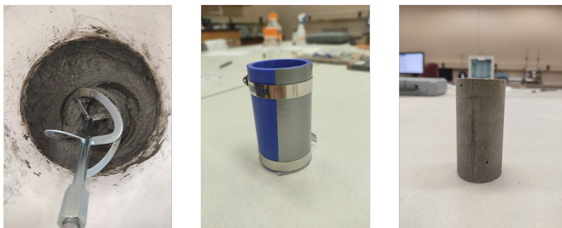
Figura 4.9 Elaboración de probetas de mortero cilíndricas
