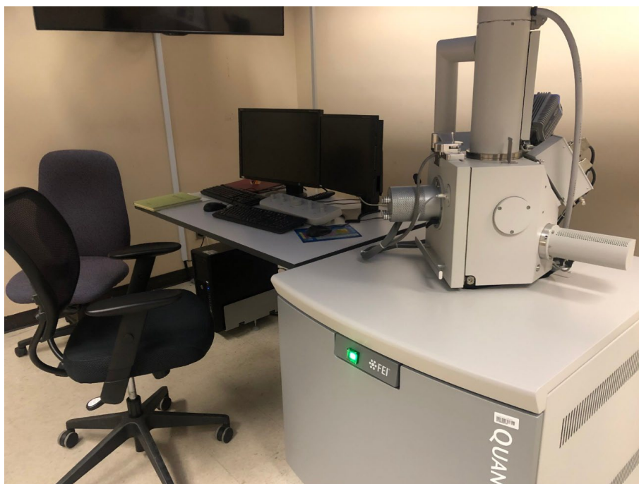
Figura 4.2 Equipo de Microscopía electrónica de barrido con detectores SE, BSE y EDX, del Samuel Roberts Noble Microscopy Laboratory (Oklahoma University).
