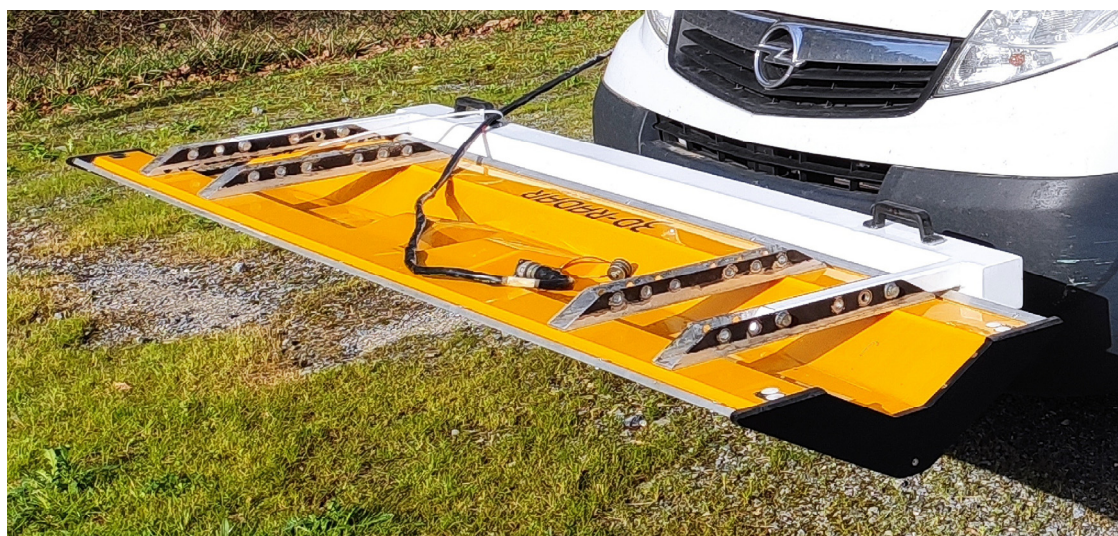
Figura 5.5.1. Antena de georradar 3D multifrecuencia montada en el vehículo de auscultación
