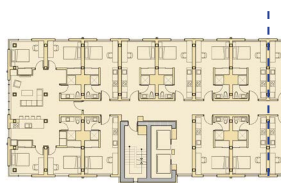
Fig. 25. Organización en malla en Brock Commons, Vancouver
