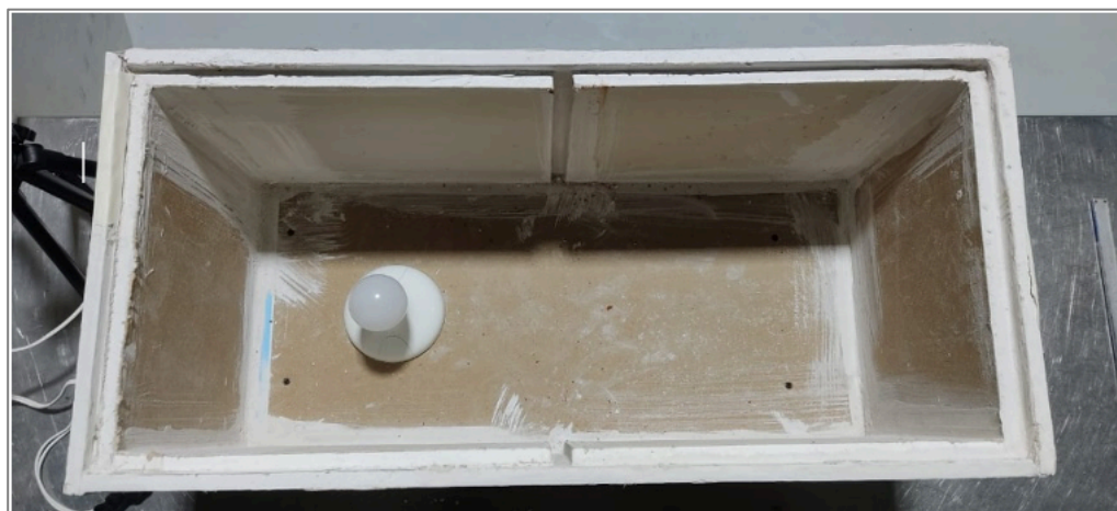
Figura 67. Instalación de fuente de calor calorímetro para ensayo
