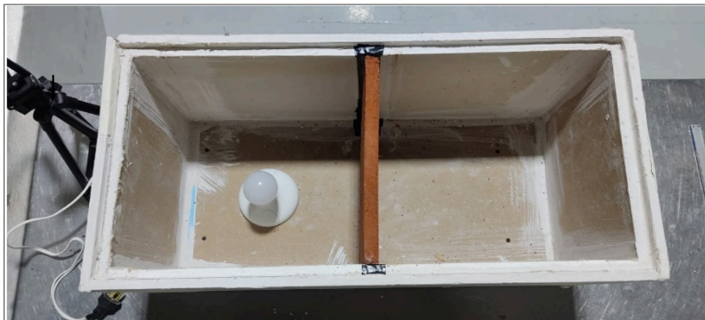
Figura 68. Colocación de placa para ensayo de forma vertical en el centro de la caja Se procede a encender el foco y se coloca la tapa del calorímetro cerrándolo herméticamente, evitando la fuga de energía como se indica en la Figura 69.
