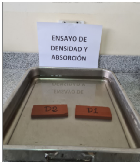
Figura 51. Inmersión de prototipos por 24 horas
