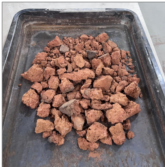
Figura 8. Residuos de ladrillos
