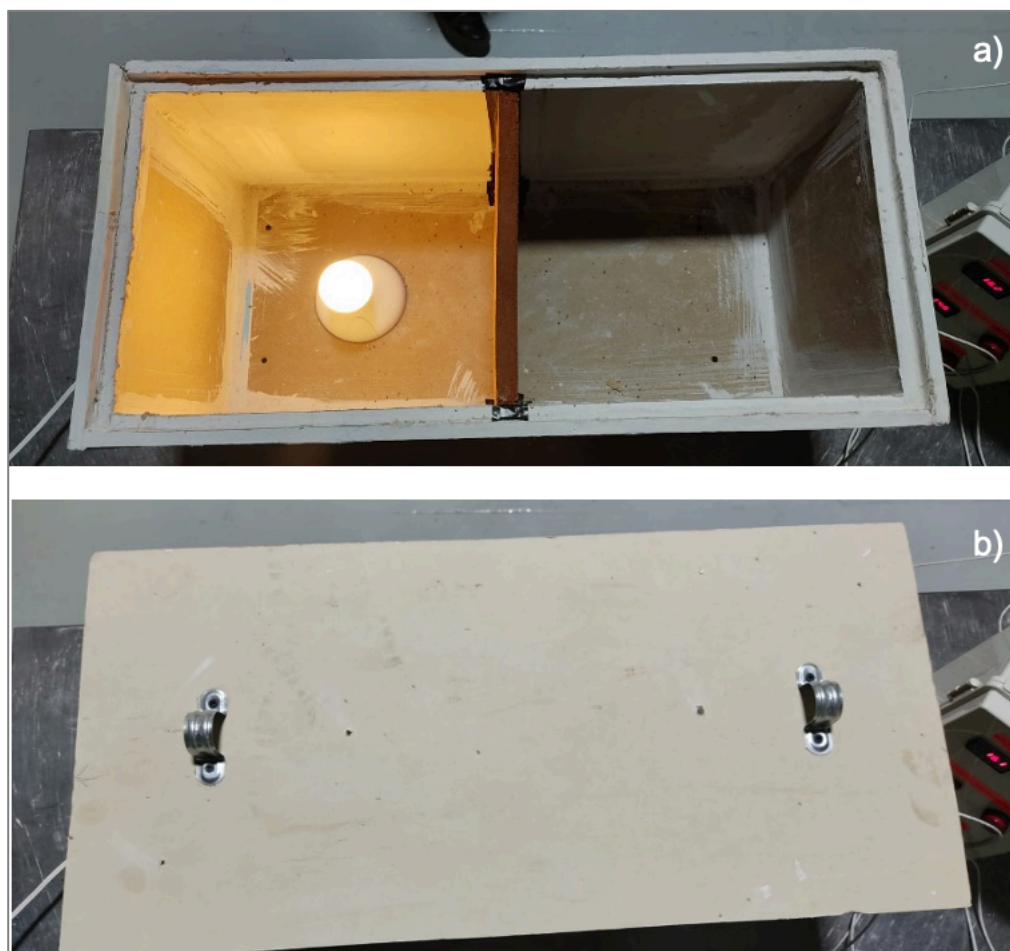
Figura 69. Encendido de emisor y sellado de caja (calorímetro) a) encendido de foco en recinto emisor b) colocación de tapa y sellado de calorímetro
