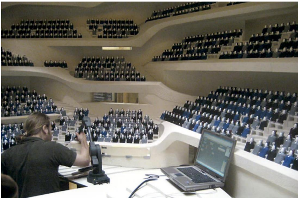
Fig. 67. Técnico realizando pruebas mediante una maqueta a escala 1/10.
