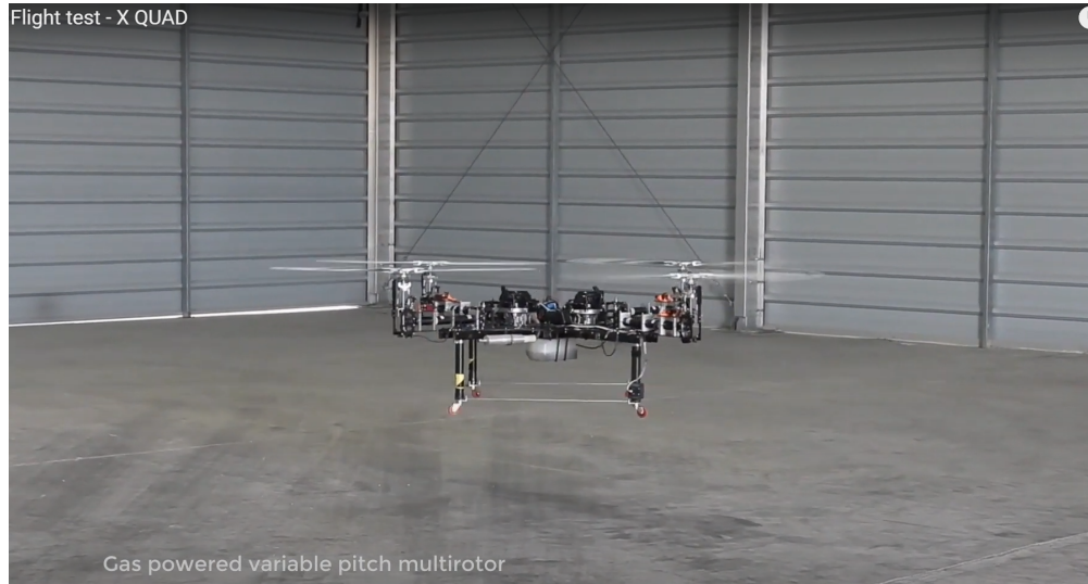
Figura A.1: Prueba de vuelo de un quadrotor de alta capacidad de carga con motores de combustión con control de paso variable
