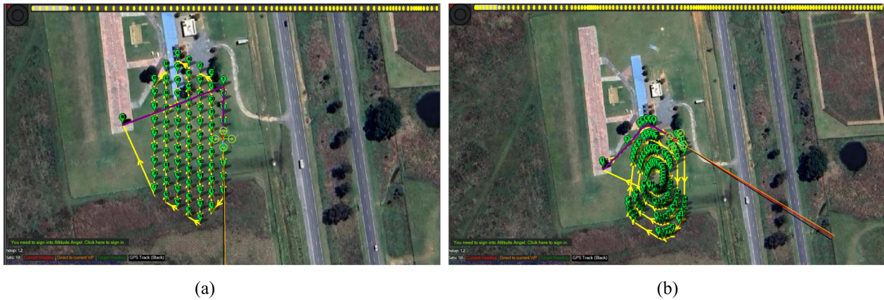
Figura 6.8: Configuración del entorno SITL para Mission Planner. a) Planificación back-and-forth. b) Planificación espiral
