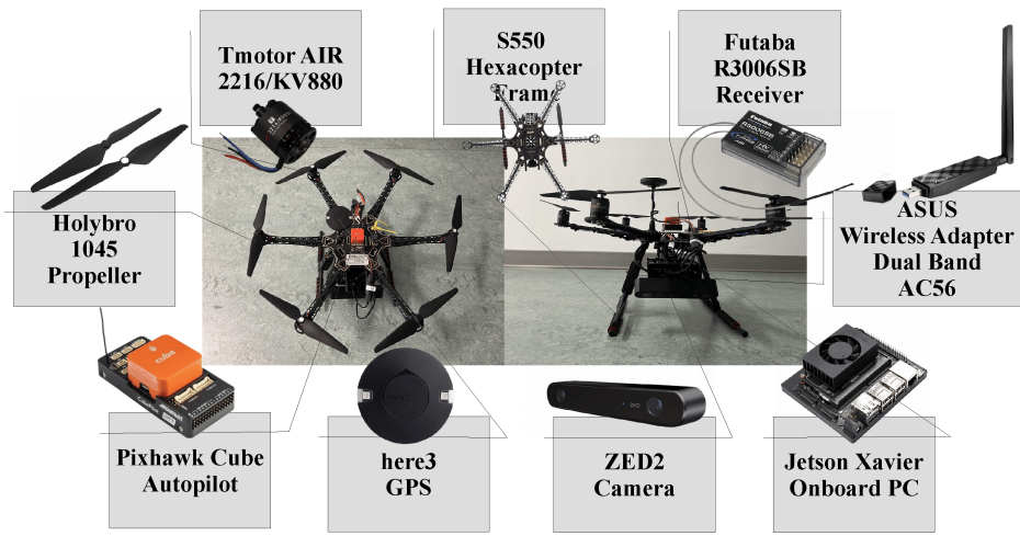
Figura 6.3: Figura tomada de (Luna et al., 2022) para mostrar el esquema de configuración del prototipo SwarmHopper utilizado en pruebas reales en el aeródromo
