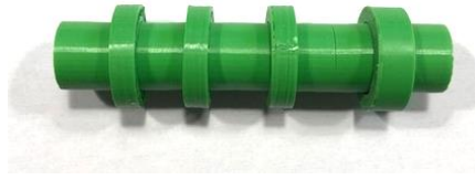
Figura 34 Prueba de impresión para determinar holguras.
