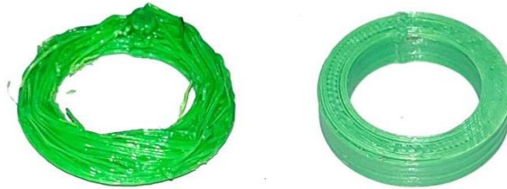
Figura 26: Anillos impresos antes y después de la reparación.
