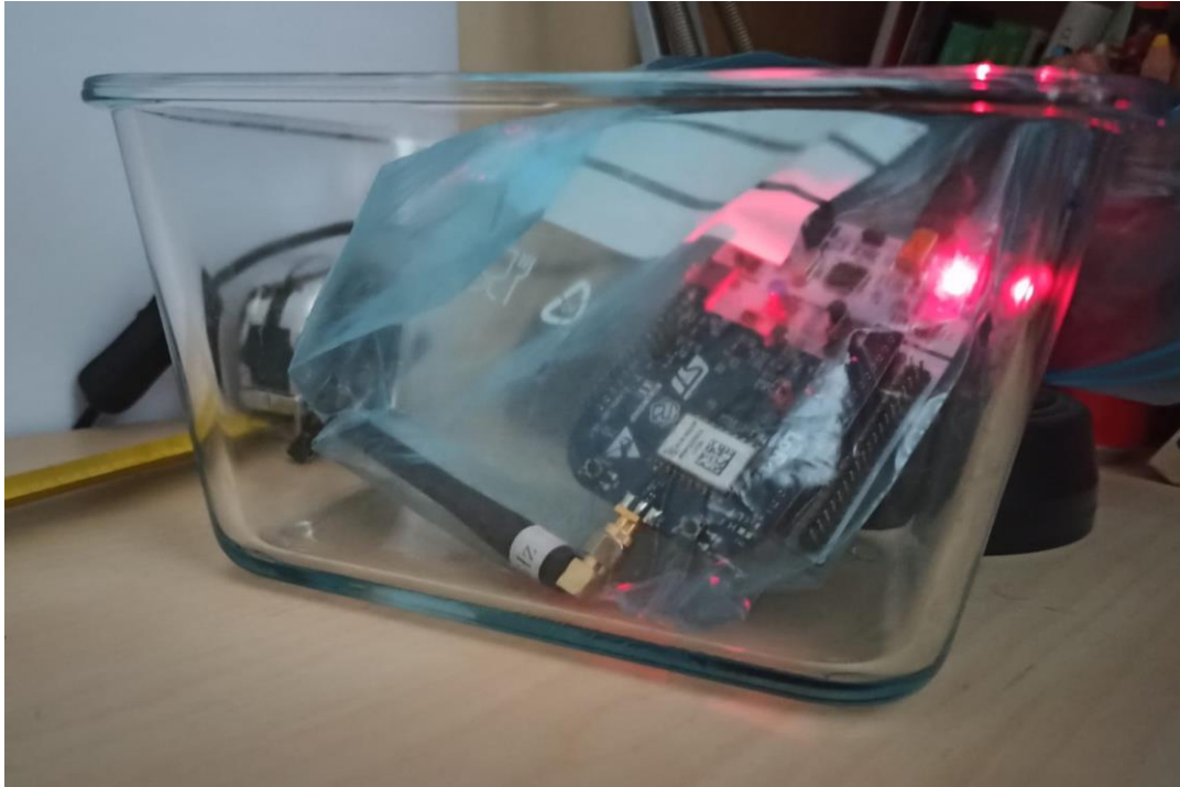
Figura 31: Nodo en bolsa de plástico y recipiente de vidrio
