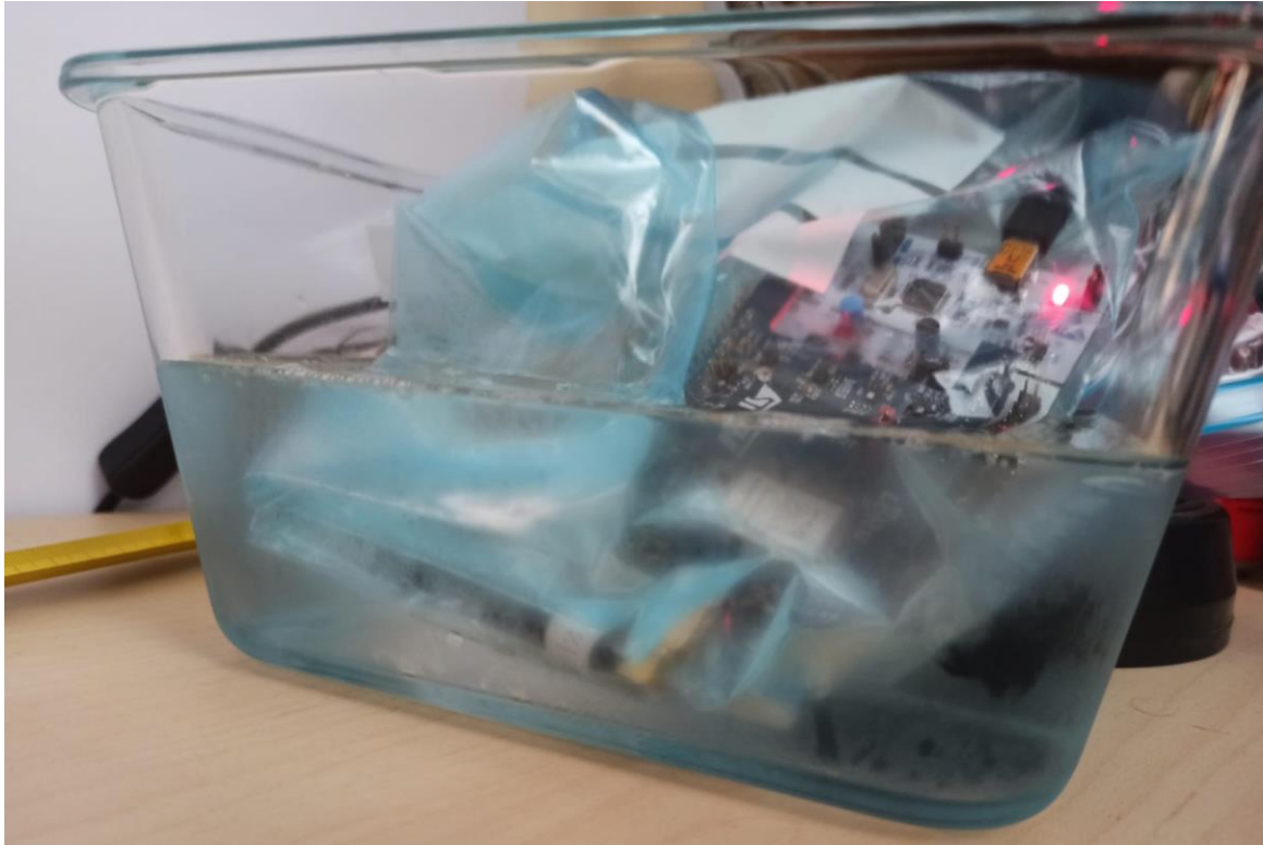
Figura 33: Ensayo en cerebro simulado. Antena sumergida en medio acuoso con las propiedades del cerebro
