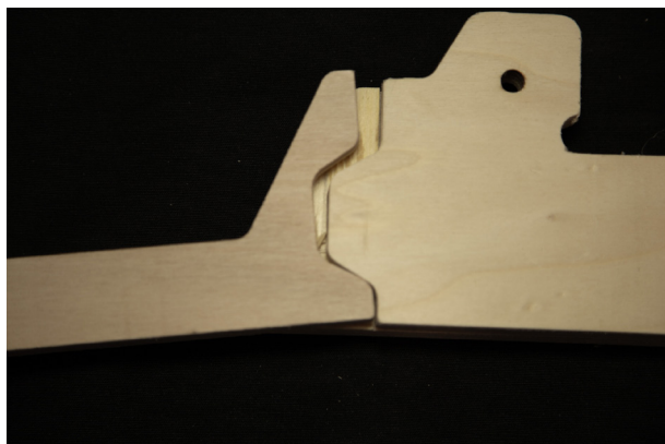
[Fig. 3.25] Modo de fallo pieza U 2 (arriba dcha.).
