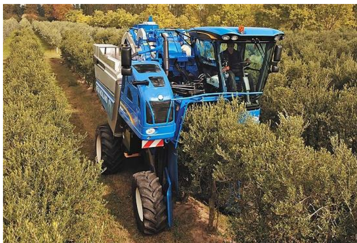
Ilustración 20 Cosechadora cabalgante autopropulsada
