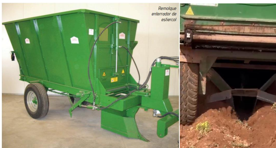
Ilustración 4 Remolque enterrador y detalle de caída de enmienda en el surco abierto y hoja que alisa el terreno
