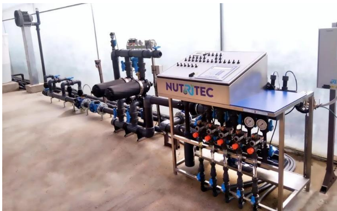
Ilustración 15 Equipo de fertirriego junto con equipo de filtrado y otros elementos del cabezal
