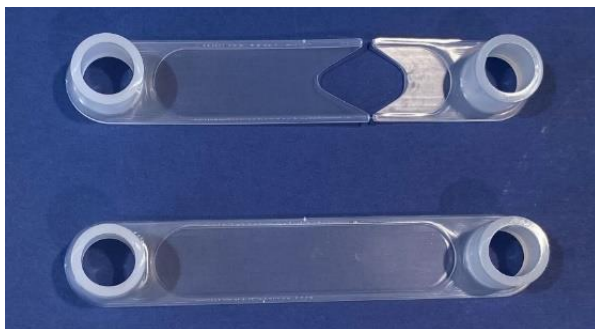
Figura 5.2.3- 2 Piezas inyectadas a 190°C con presiones de inyección de 65 bar (superior) y 70 bar (inferior)
