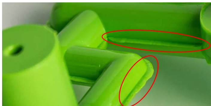
Figura 1.3.2- 1 Rebabas en una pieza fabricada mediante inyección [31]
