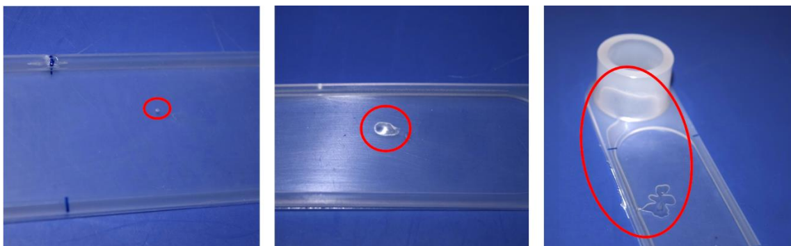
Figura 4.3.4- 2 Burbujas que aparecen en las piezas fabricadas debido a una pequeña imperfección en el molde
