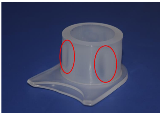
Figura 4.4.4- 4 Rechupes en los cilindros de las piezas fabricadas
