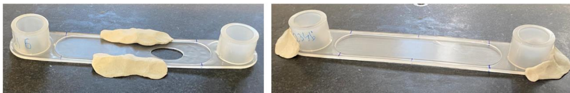
Figura 4.4.4- 6 Fijación de piezas cóncava (izquierda) y convexa (derecha) para su medición con la máquina de coordenadas
