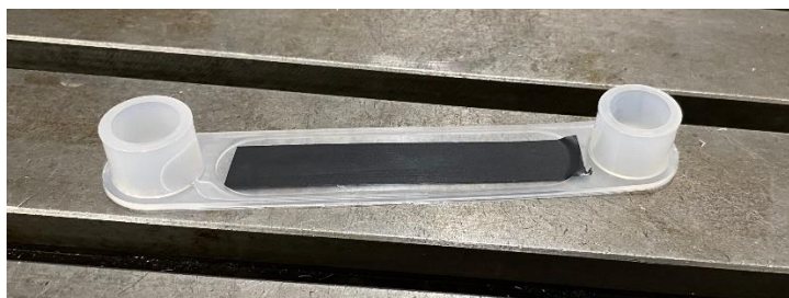
Figura 4.4.5- 3 Pieza acondicionada para ser medida con el sensor láser
