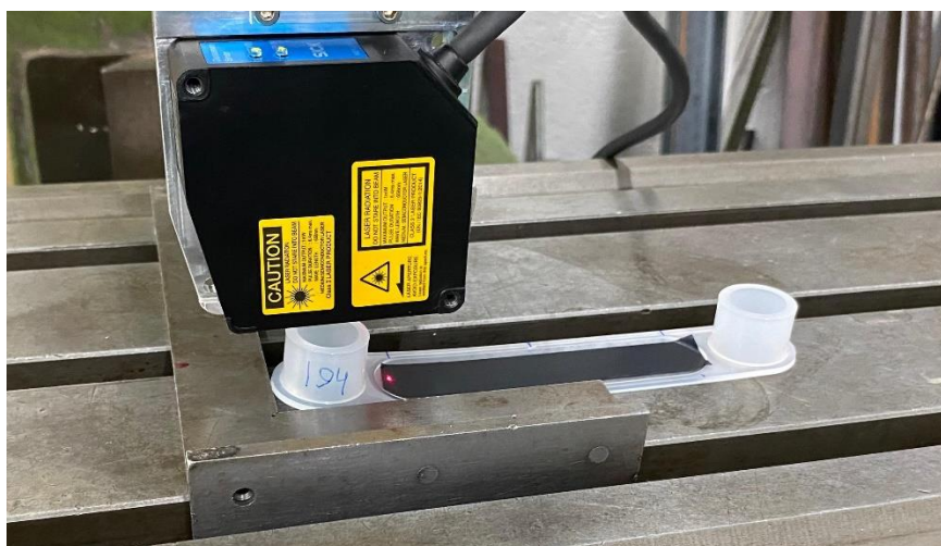
Figura 4.4.5- 4 Medición del alabeo de una de las piezas con el sensor láser
