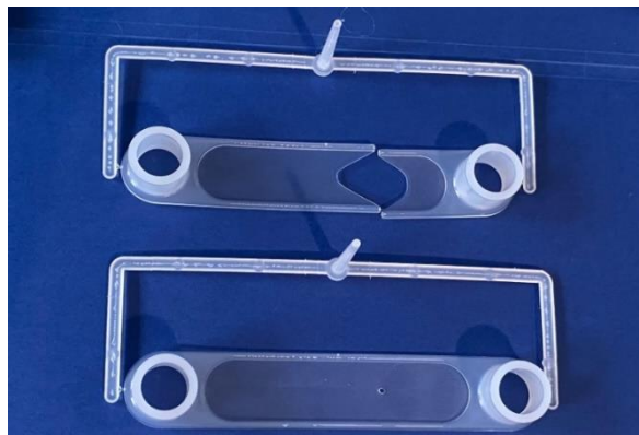
Figura 5.2.3- 1 Piezas inyectadas a 250°C con presiones de inyección de 35 bar (superior) y 40 bar (inferior)
