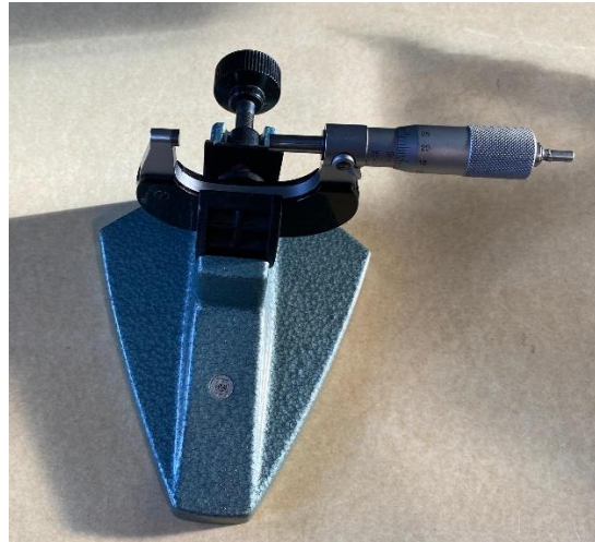
Figura 4.4.3- 1 Micrómetro empleado en el proyecto junto con su elemento de soporte
