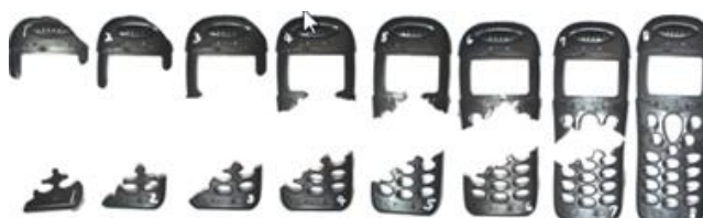
Figura 1.3.1- 1 Piezas inyectadas que presentan un defecto de falta de llenado [30]
