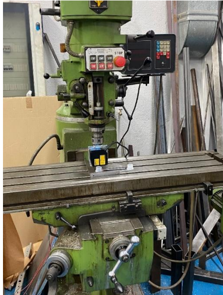
Figura 4.4.5- 1 Montaje del sensor láser sobre la fresadora
