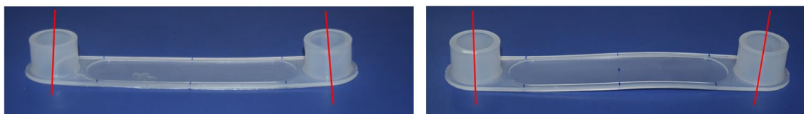
Figura 4.4.4- 5 Piezas con alabeo cóncavo (izquierda) y convexo (derecha)
