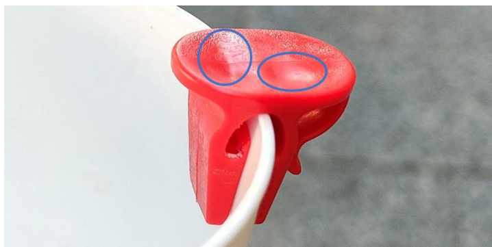
Figura 1.3.3- 1 Pieza inyectada con rechupes en una de sus superficies [33]
