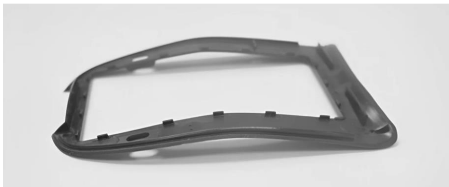
Figura 1.3.6- 1 Pieza inyectada que se ha alabeado durante su enfriamiento [35]
