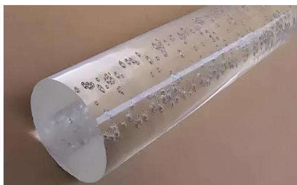
Figura 1.3.4- 1 Pieza fabricada por inyección con burbujas de aire retenido [34]
